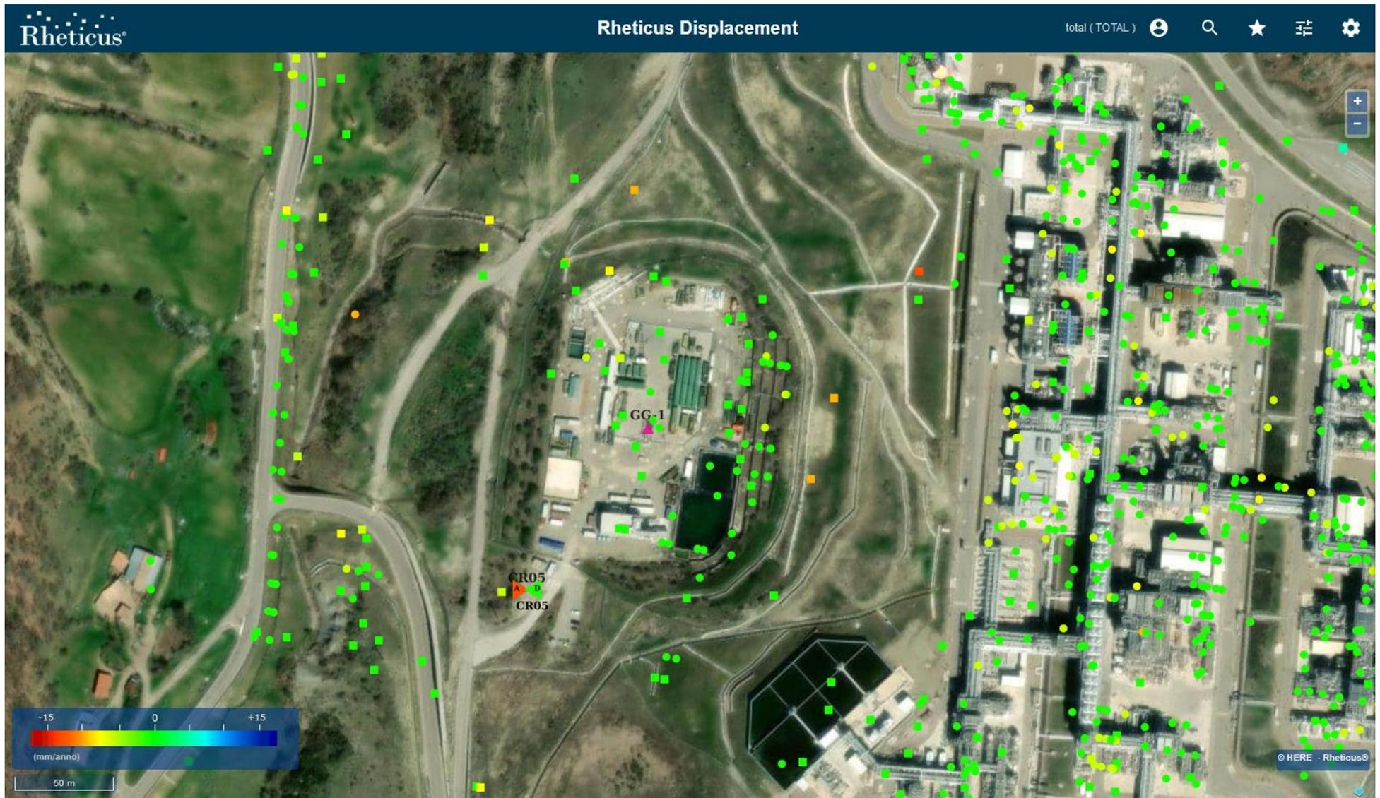
Figura 12: **Pozzo GG-1** (indicato dal triangolo fucsia) caratterizzato da una buona copertura di PS e dai quali, nel periodo esteso a Giungo 2023, non si evincono variazioni significative di velocità media rispetto al precedente rapporto [RD14].
