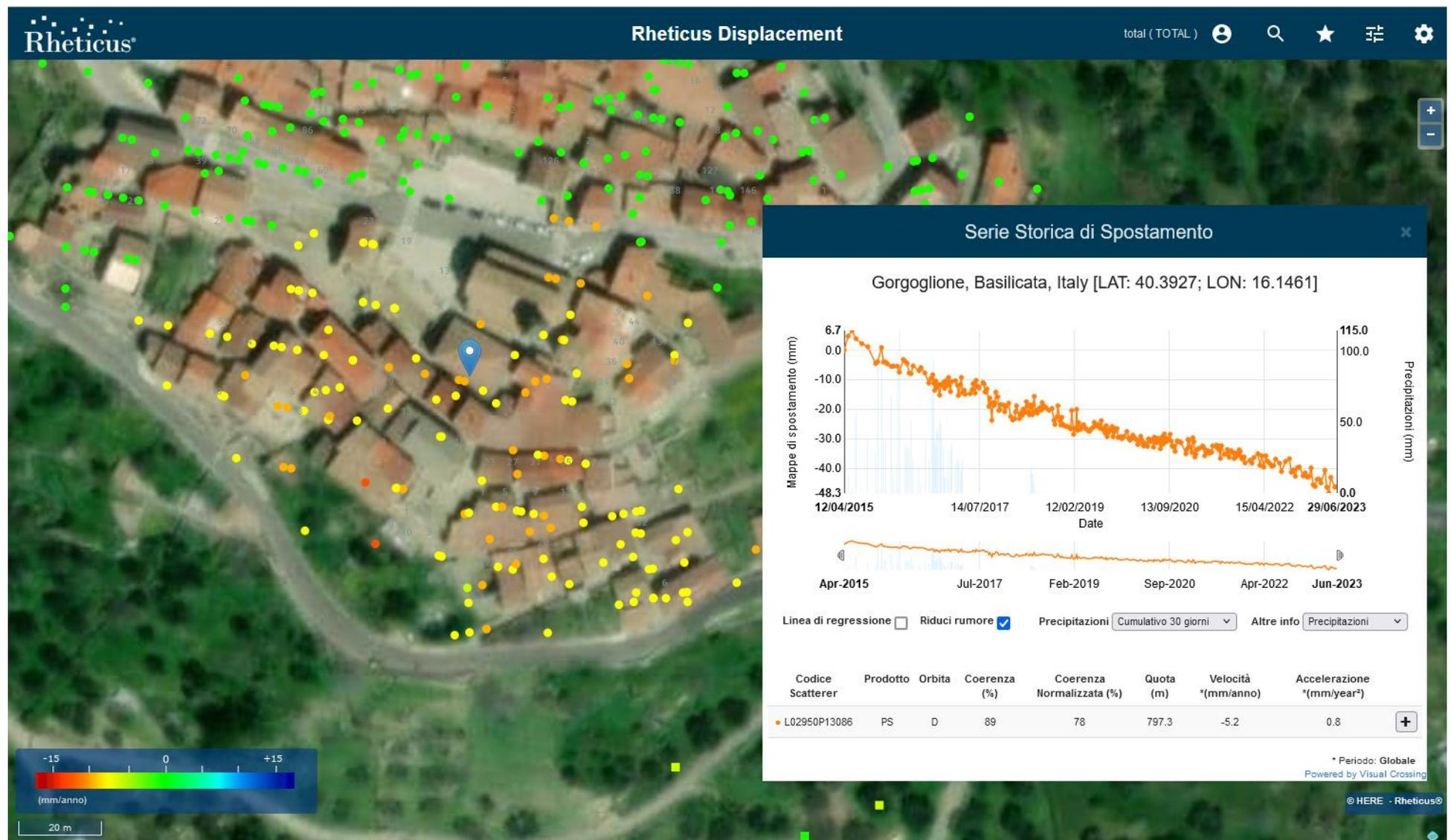
Figura 8: Serie temporale del PS (evidenziato dal puntatore blu nell'immagine) ad alta coerenza (0.89) situato al centro dell'area in movimento del centro abitato di **Gorgoglione**. La velocità media del PS sul periodo esteso a Giugno 2023 è pari a -5.2 mm/anno in linea con quanto misurato nel precedente rapporto [RD14].
