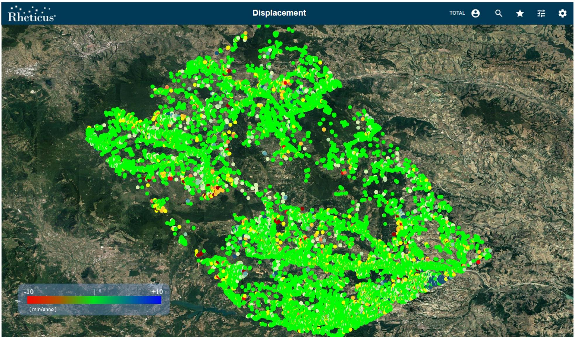
Figura 6: Mappa velocità media annua (mm/anno) in direzione Est(+) - Ovest(-) sul periodo esteso a Giugno 2023 ottenuta dalla combinazione delle immagini Ascending e Descending acquisite dal satellite Sentinel-1.
