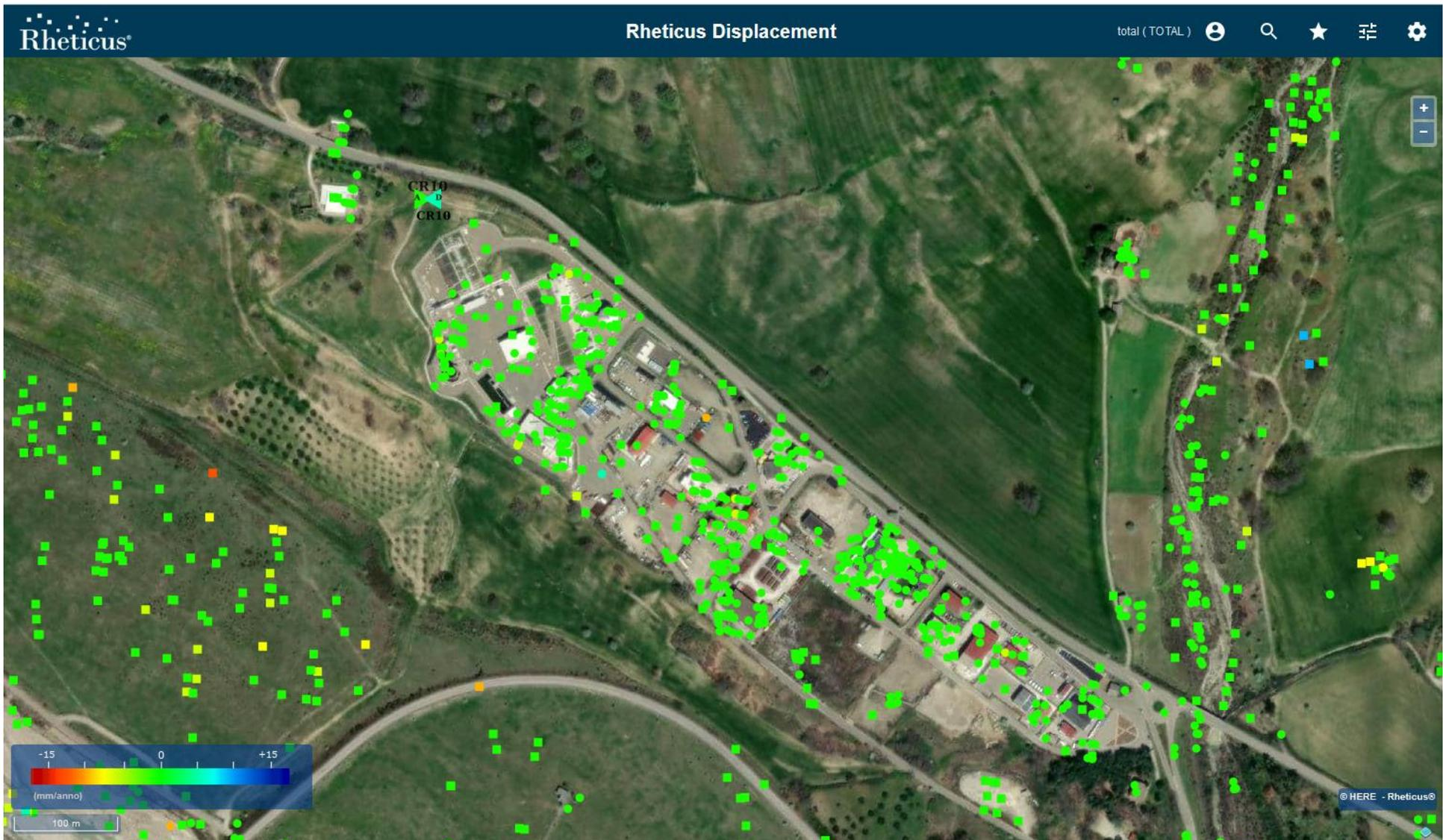
Figura 30: **LPG Center** caratterizzato da una buona copertura di PS e dai quali nel periodo esteso a Giugno 2023, non si evincono variazioni significative di velocità media rispetto al precedente rapporto [RD14].
