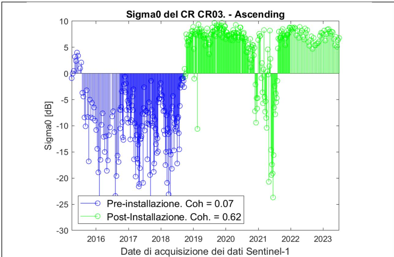
Fig. 0.10: Analisi radiometrica della serie temporale (modalità ascending) in corrispondenza del corner reflector CR03. In blu sono indicate le misure pre-installazione. In verde sono indicate le misure post-installazione.
