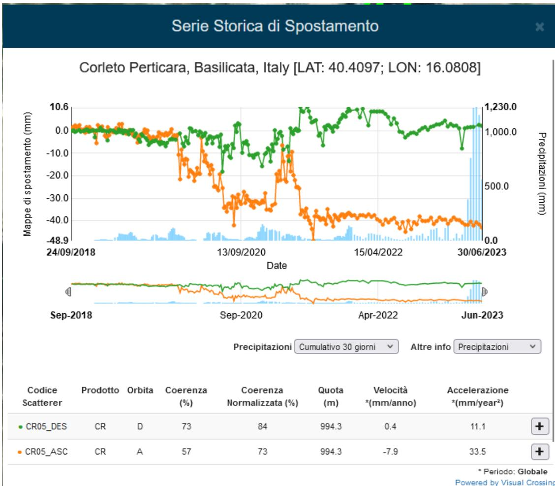
Figura 13: serie temporale di spostamento relativa al periodo settembre 2018 – Giugno 2023 misurata in corrispondenza del Corner Reflector CR05. La serie temporale di spostamento in arancione è relativa all’orbita Ascending mentre quella verde rappresenta la serie temporale relativa all’orbita Descending.
