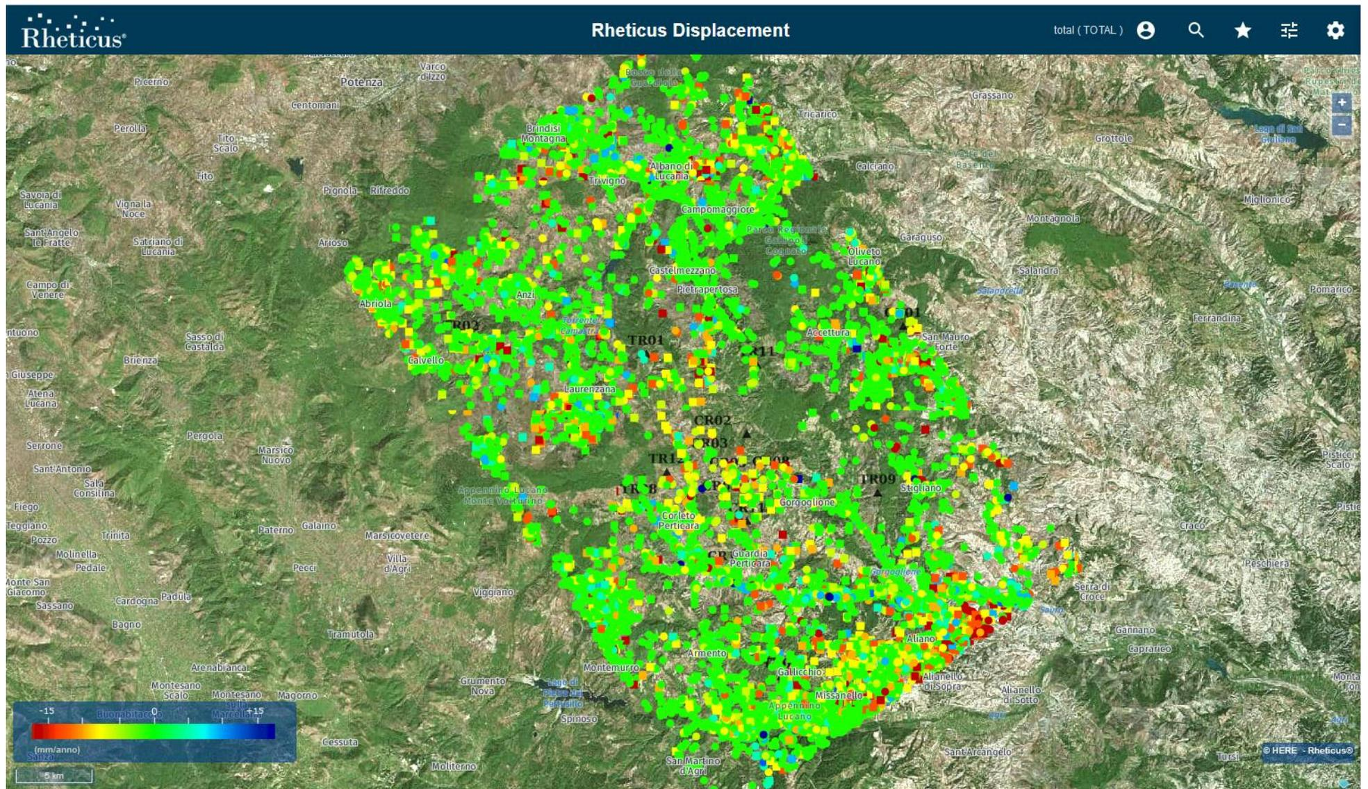
Figura 3: Mappa velocità media annua (mm/anno) lungo la LOS sul periodo esteso a Giugno 2023 ottenuta dal processamento del dataset Sentinel-1 in orbita ascending.
