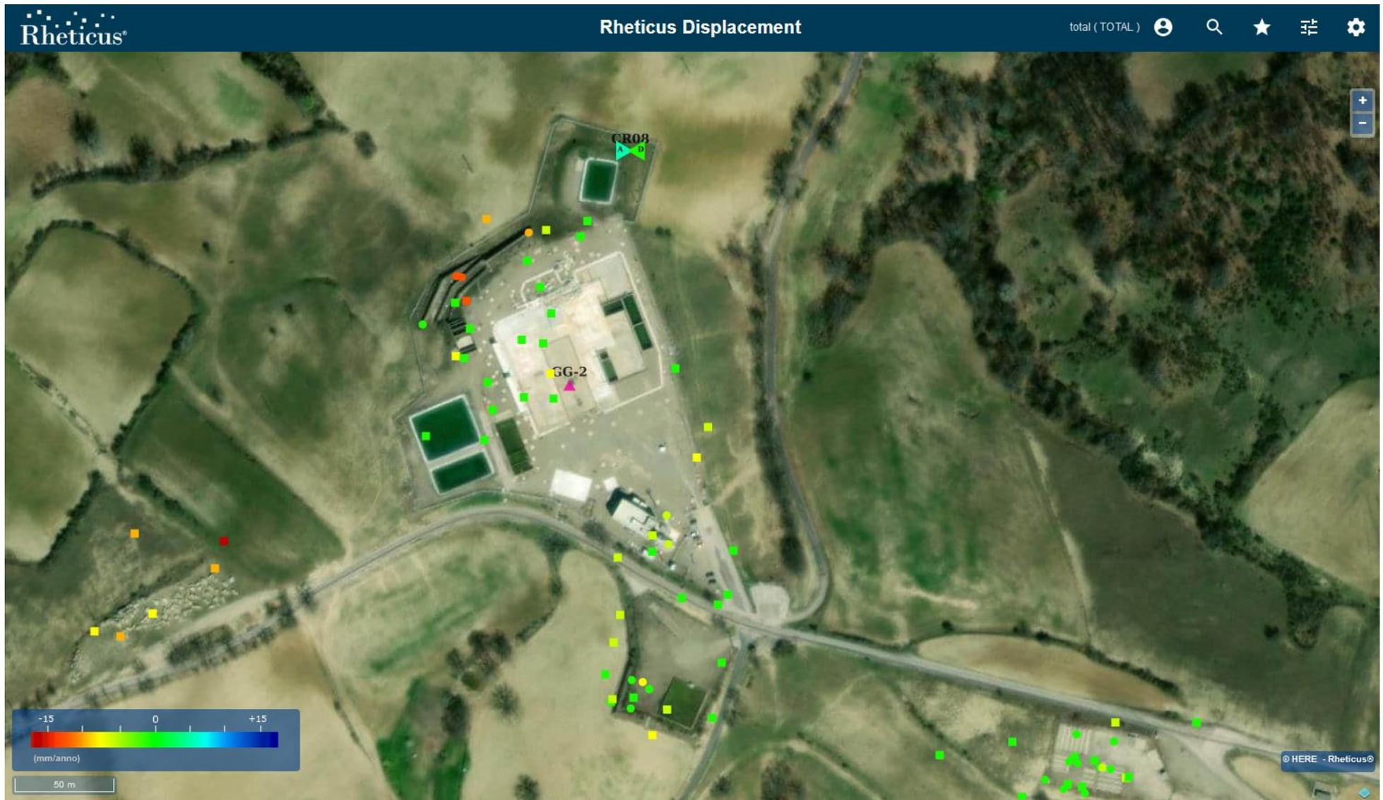
Figura 15: **Pozzo GG-2** (indicato dal triangolo fucsia) caratterizzato da una buona copertura di PS e dai quali, nel periodo esteso a Giungo 2023, non si evincono variazioni significative di velocità media rispetto al precedente rapporto [RD14].
