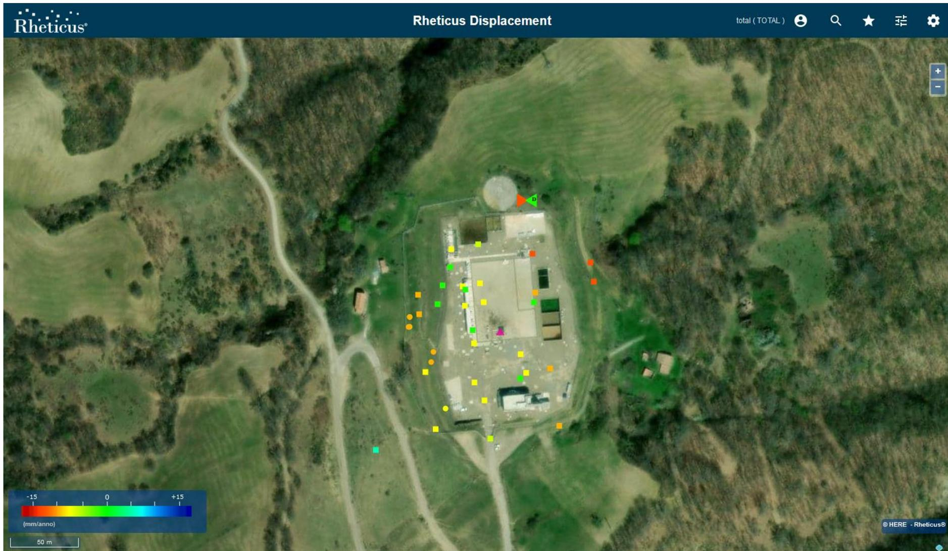
Figura 18: **Pozzo TE-1** (indicato dal triangolo fucsia) caratterizzato da una buona copertura di PS e dai quali nel periodo esteso a Giugno 2023, non si evincono variazioni significative di velocità media rispetto al precedente rapporto [RD14].
