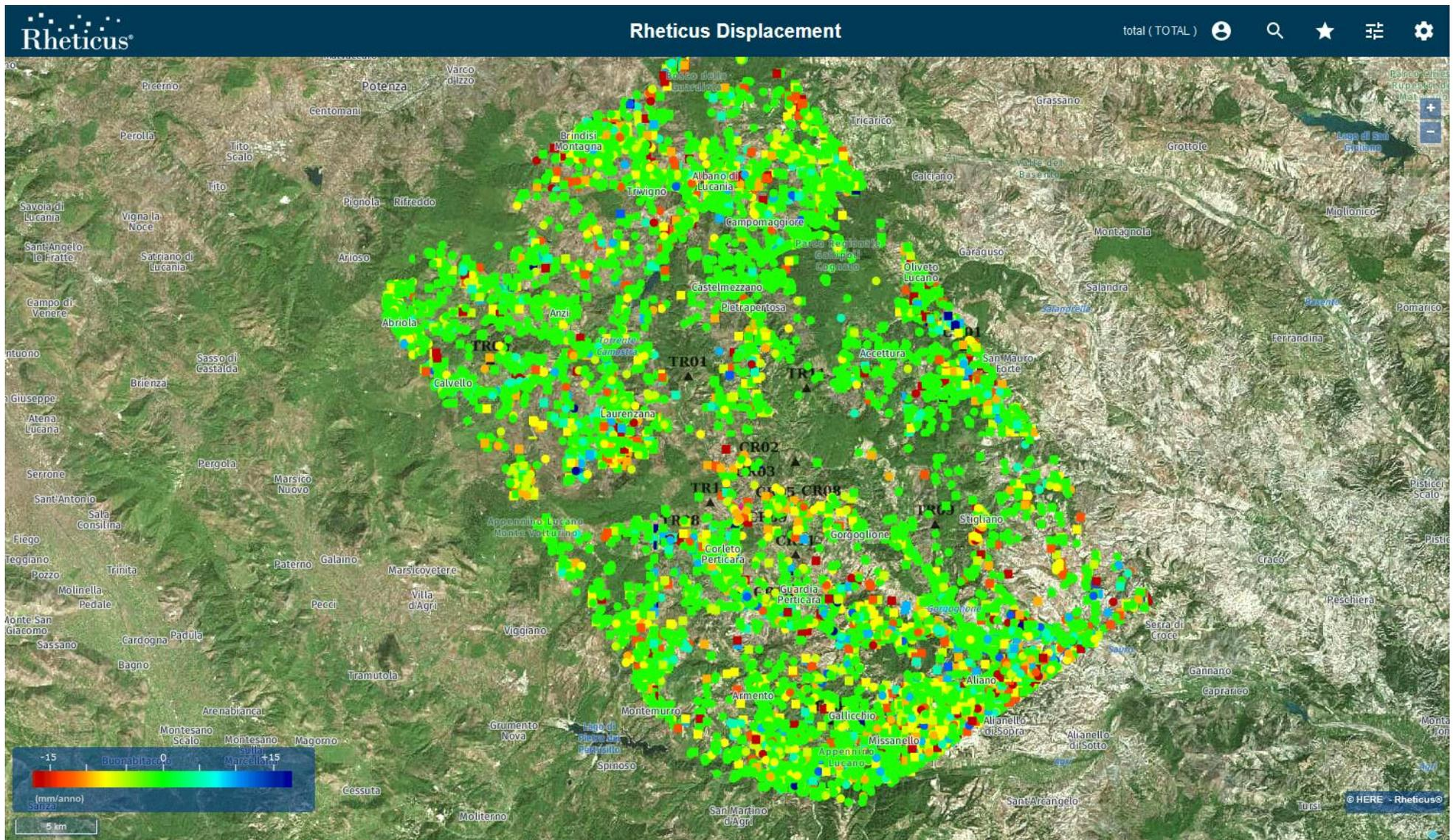
Figura 4: Mappa velocità media annua (mm/anno) lungo la LOS sul periodo esteso a Giugno 2023 ottenuta dal processamento del dataset Sentinel-1 in orbita descending.
