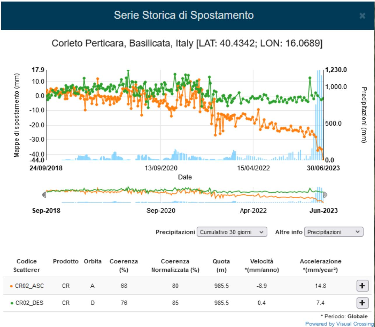
Figura 19: serie temporale di spostamento relativa al periodo settembre 2018 – Giugno 2023 misurata in corrispondenza del Corner Reflector CR02. La serie temporale di spostamento in verde è relativa all’orbita Descending mentre quella arancione rappresenta la serie temporale relativa all’orbita Ascending.
