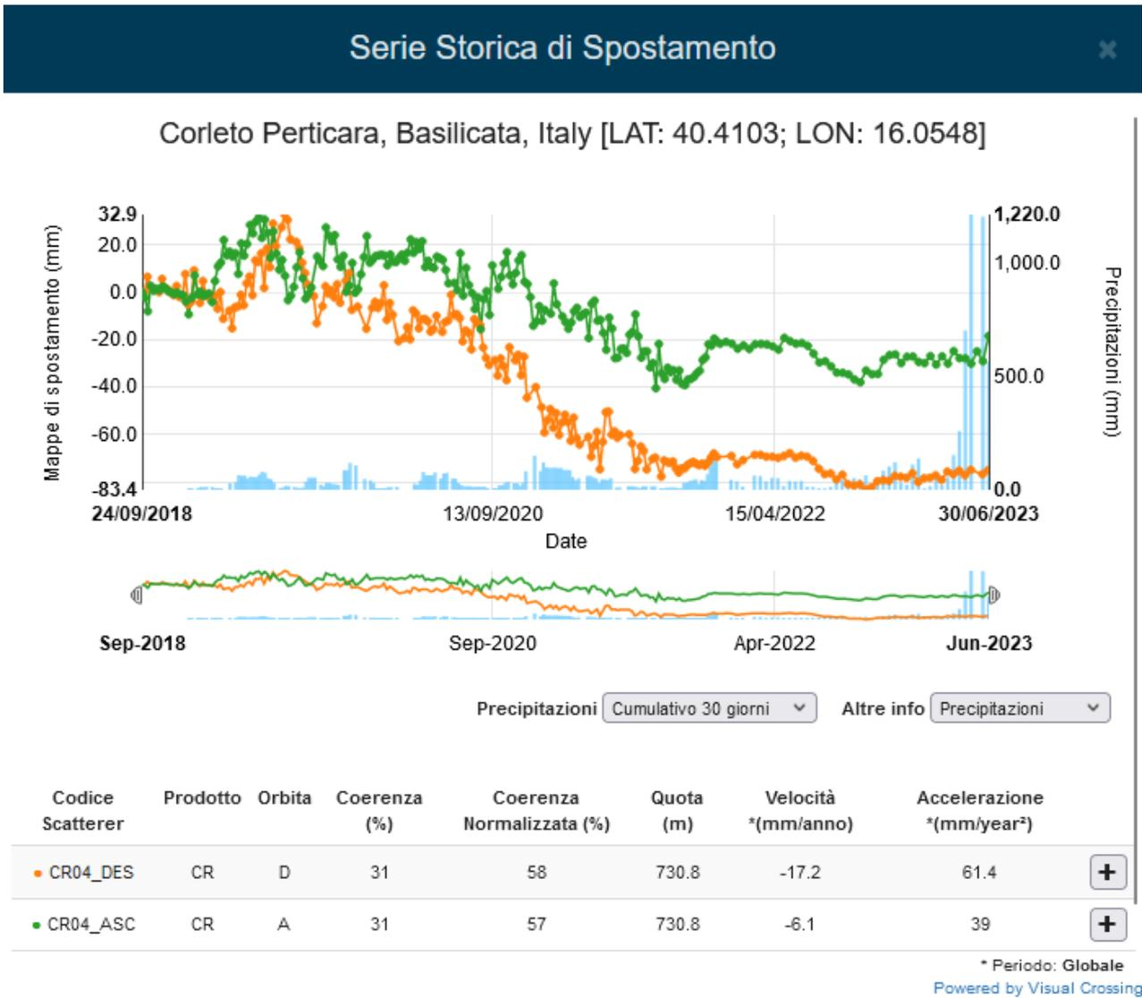
Figura 22: serie temporale di spostamento relativa al periodo settembre 2018 – Giugno 2023 misurata in corrispondenza del Corner Reflector CR04. La serie temporale di spostamento in verde è relativa all’orbita Ascending mentre quella arancione rappresenta la serie temporale relativa all’orbita Descending.
