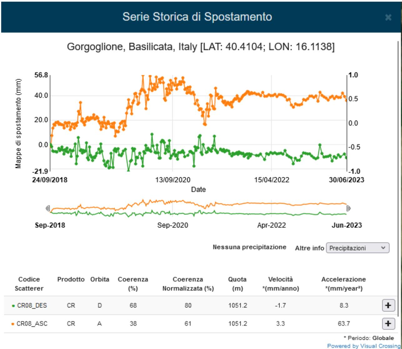
Figura 16: serie temporale di spostamento relativa al periodo settembre 2018 – Giugno 2023 misurata in corrispondenza del Corner Reflector CR08. La serie temporale di spostamento in arancione è relativa all’orbita Ascending mentre quella verde rappresenta la serie temporale relativa all’orbita Descending.
