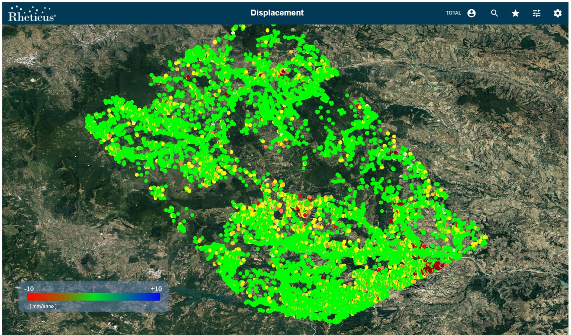
Figura 5: Mappa velocità media annua (mm/anno) lungo la direzione verticale sul periodo esteso a Giugno 2023 ottenuta dalla combinazione delle immagini Ascending e Descending acquisite dal satellite Sentinel-1.
