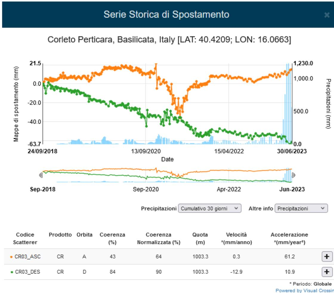
Figura 25: serie temporale di spostamento relativa al periodo settembre 2018 – Giugno 2023 misurata in corrispondenza del Corner Reflector CR03. La serie temporale di spostamento in verde è relativa all'orbita Descending mentre quella arancione rappresenta la serie temporale relativa all'orbita Ascending.
