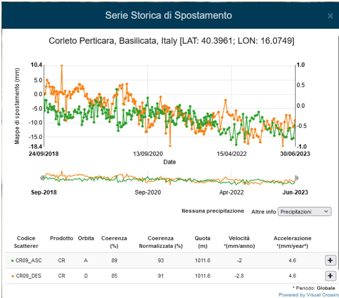
Figura 28: serie temporale di spostamento relativa al periodo settembre 2018 – Giugno 2023 misurata in corrispondenza del Corner Reflector CR09. La serie temporale di spostamento in verde è relativa all’orbita Ascending mentre quella arancione rappresenta la serie temporale relativa all’orbita Descending.
