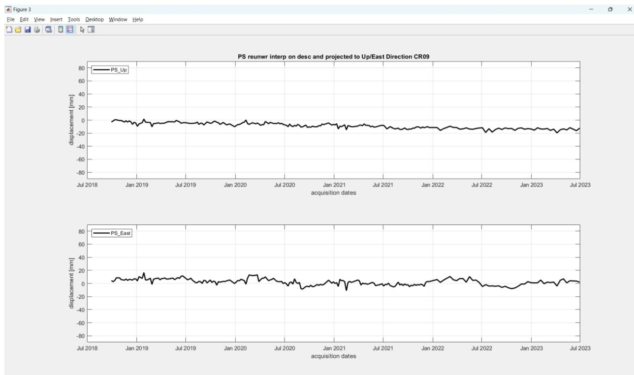
Figura 29: il grafico in alto rappresenta la serie temporale di spostamento in direzione Verticale (PS\_Up) mentre il grafico in basso rappresenta la serie temporale di spostamento in direzione est (PS\_Est).
