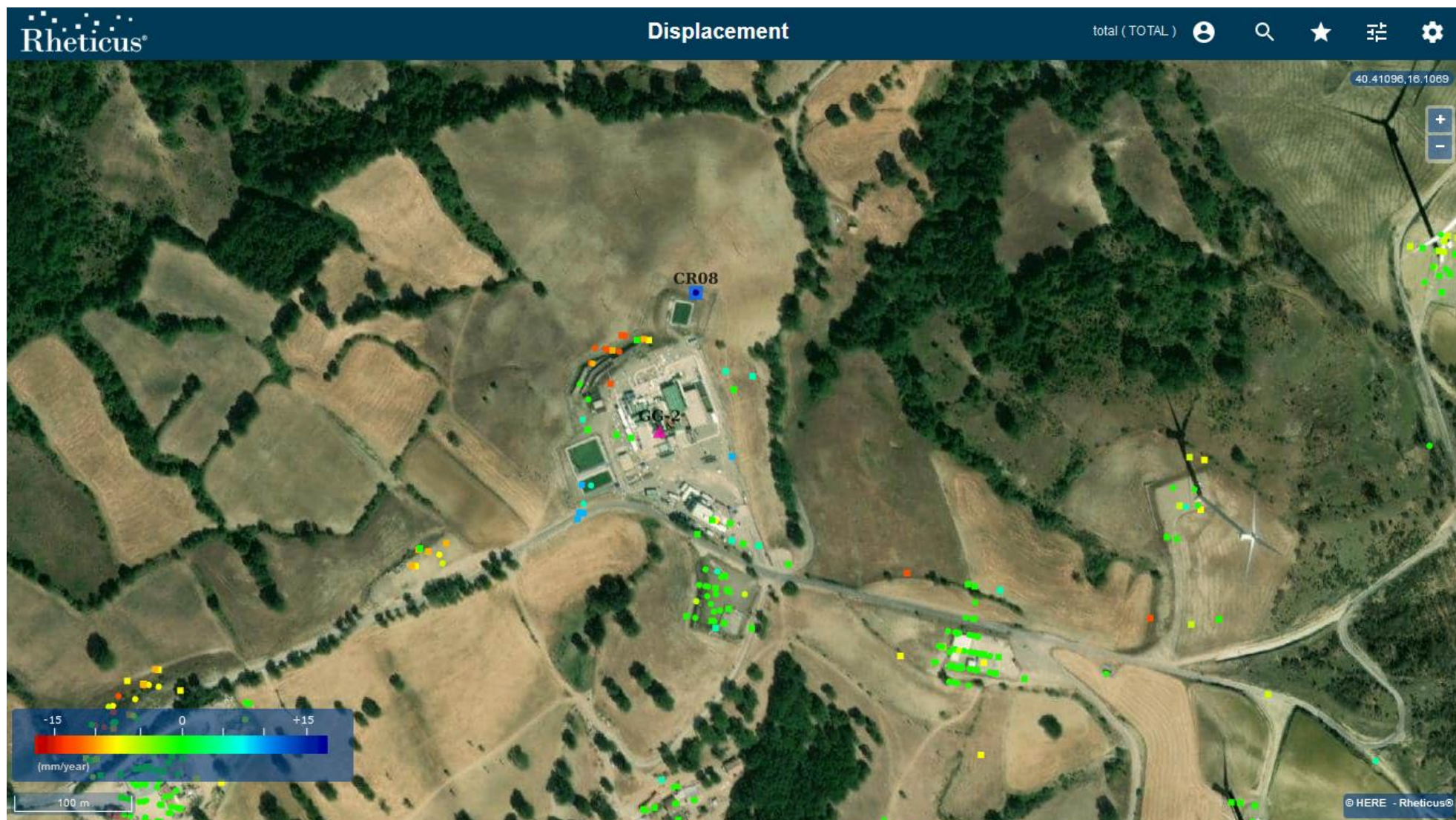
Figura 15: Pozzo GG-2 (indicato dal triangolo fucsia) caratterizzato da una buona copertura di PS e dai quali, nel periodo esteso a Giugno 2020, non si evincono variazioni significative di velocità media rispetto al precedente rapporto [RD8].
