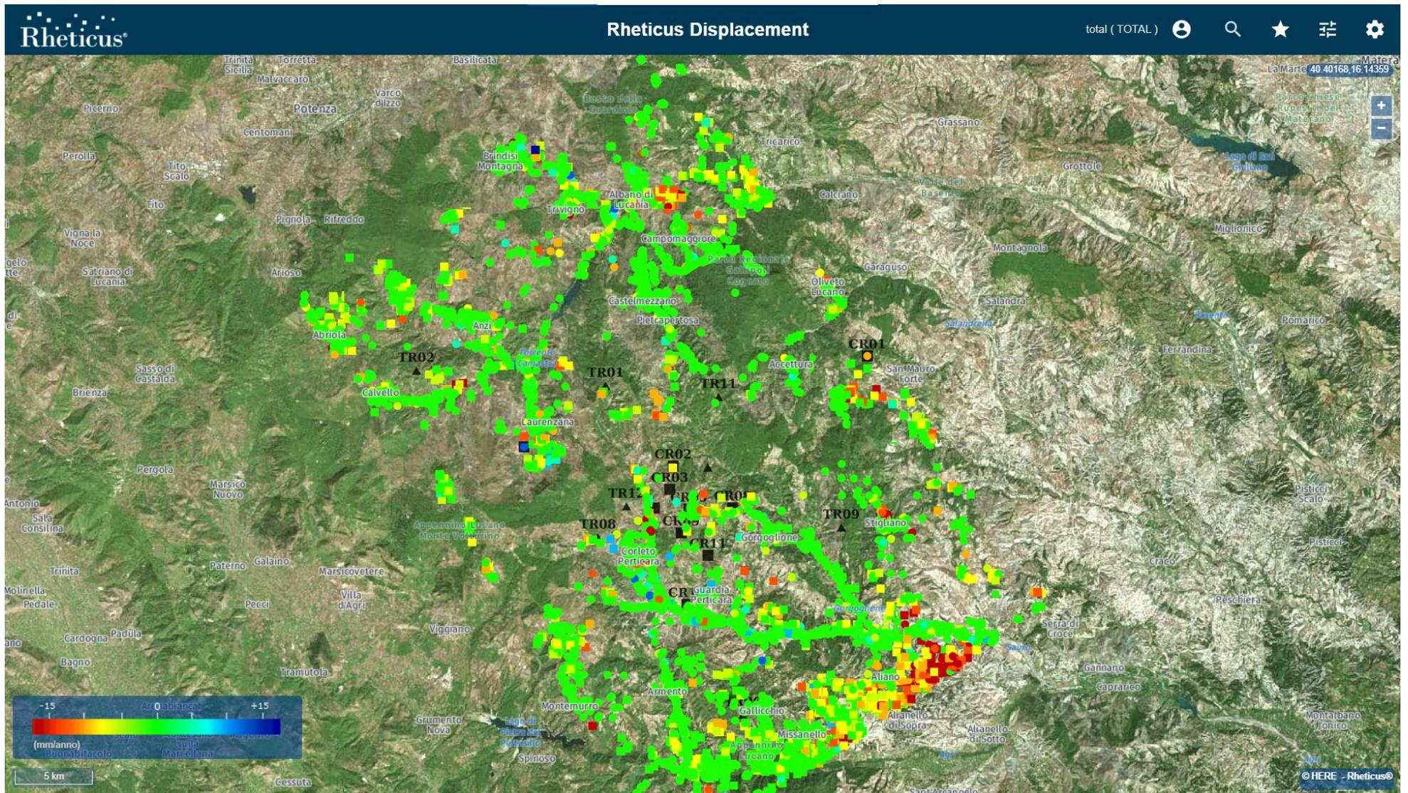
Figura 3: Mappa velocità media annua (mm/anno) lungo la LOS sul periodo esteso a Giugno 2021 e ottenuta dal processamento del dataset Sentinel-1 in orbita ascending.
