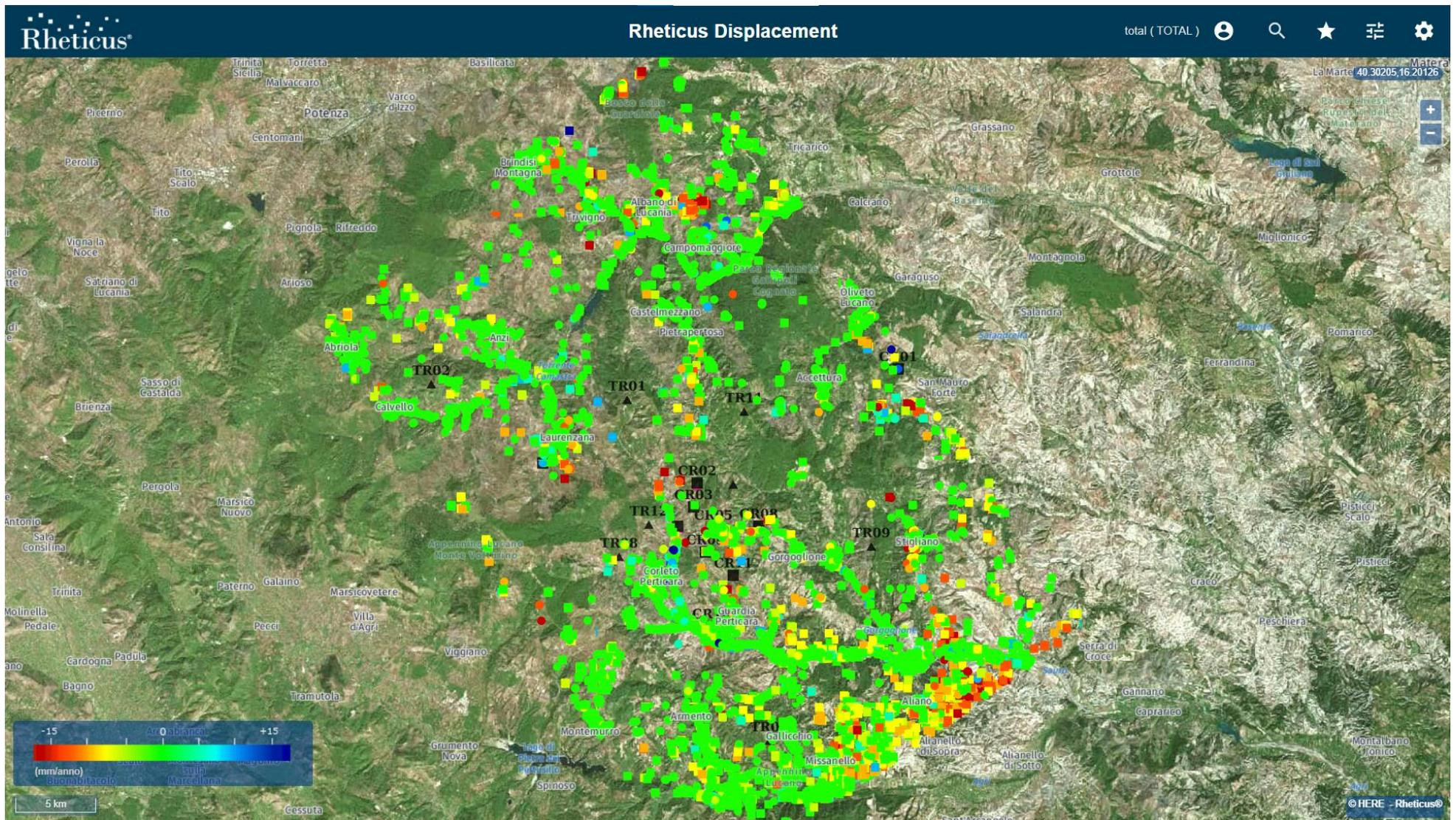
Figura 4: Mappa velocità media annua (mm/anno) lungo la LOS sul periodo esteso a Giugno 2021 e ottenuta dal processamento del dataset Sentinel-1 in orbita descending.
