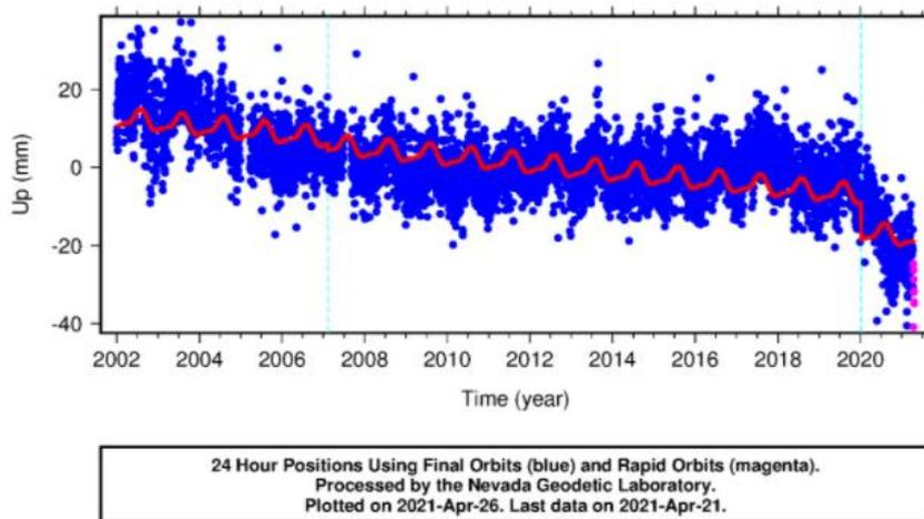
Figura 37: Movimento verticale della stazione GNSS TITO assunta come riferimento per le misure GNSS.
