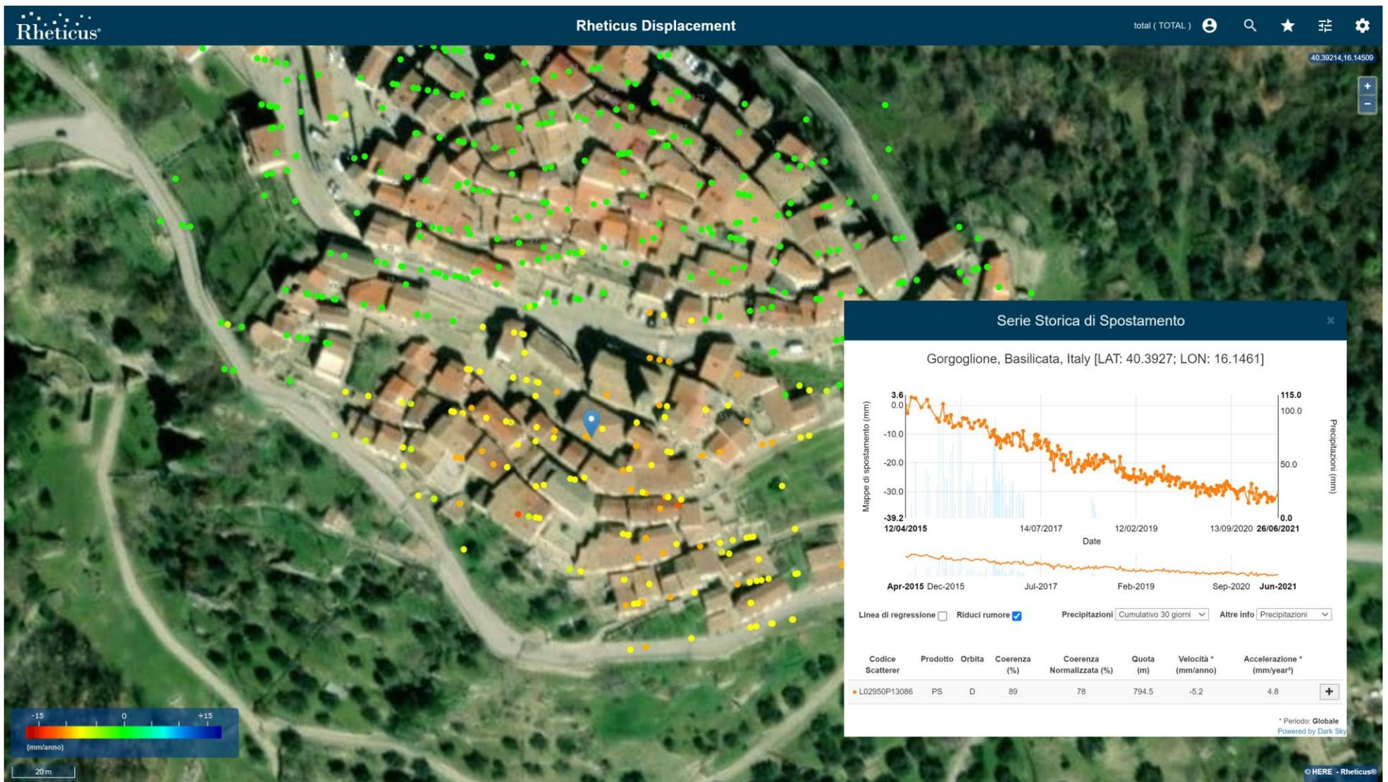
Figura 8: Serie temporale del PS (evidenziato dal puntatore blu nell'immagine) ad alta coerenza (0.89) situato al centro dell'area in movimento del centro abitato di **Gorgoglione**. La velocità media del PS sul periodo esteso a Giugno 2021 è pari a -5.2 mm/anno in linea con quanto misurato nel precedente rapporto [RD10].
