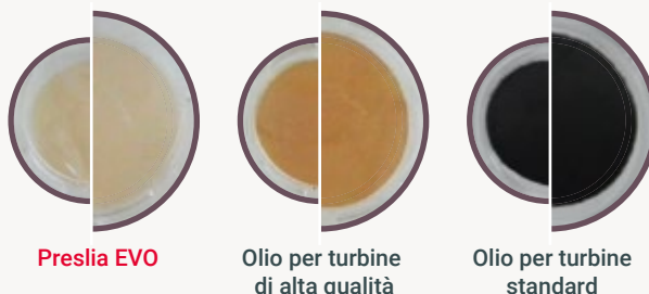
Test MAN LTAT: intasamento del filtro dopo stress termico (180°C)
