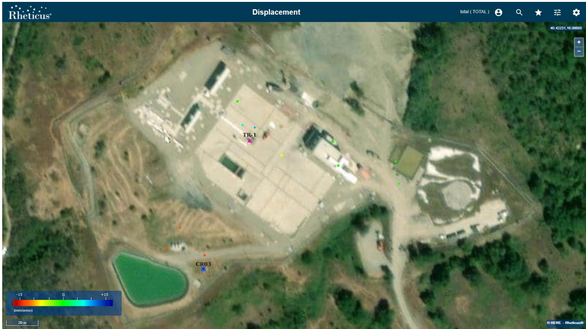
Figura 24: Pozzo TR-1 (indicato dal triangolo fucsia) Nel periodo esteso a Dicembre 2020, non si evincono variazioni significative di velocità media rispetto al precedente rapporto [RD9]. Dai PS verdi presenti si evince come la parte est della piazzola non è influenzata dal fenomeno franoso situato a monte della stessa.
