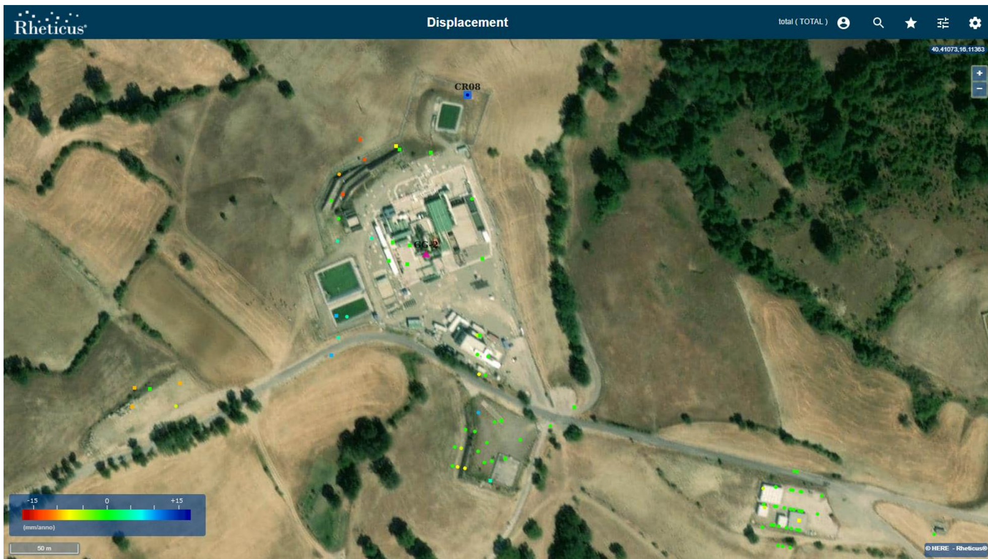
Figura 15: Pozzo GG-2 (indicato dal triangolo fucsia) caratterizzato da una buona copertura di PS e dai quali, nel periodo esteso a Dicembre 2020, non si evincono variazioni significative di velocità media rispetto al precedente rapporto [RD9].
