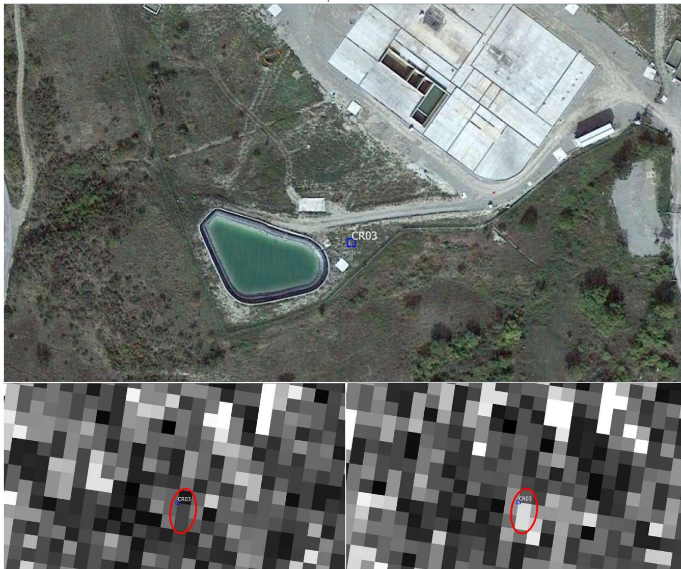
Figura 39: In alto l'immagine con la posizione del CR-03 (quadrato blu) installato nella zord sud del piazzale TR-1. Dal confronto di intensità sull' orbita Ascending pre (immagine in basso a sinistra acquisita il 14 luglio 2018) - post installazione (immagine in basso a destra acquisita il 25 Agosto 2018) si nota un netto miglioramento della risposta in ampiezza sulla zona in prossimità del CR (zona evidenziata dai cerchi rossi).
