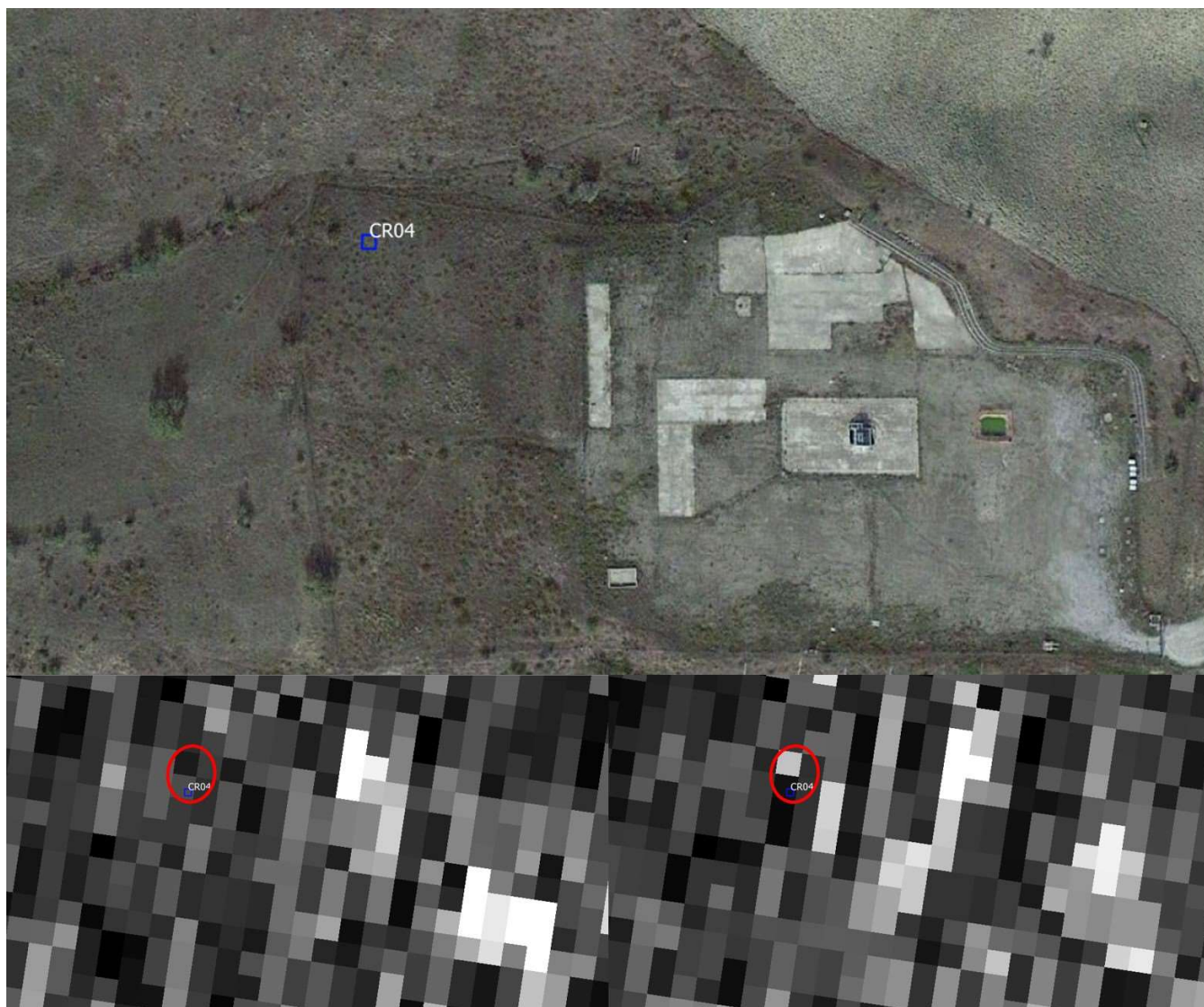
Figura 42: In alto l'immagine con la posizione del CR-04(quadrato blu) installato ad ovest del piazzale PT-1. Dal confronto di intensità sull' orbita Descending pre (immagine in basso a sinistra acquisita il 19 luglio 2018) - post installazione (immagine in basso a destra acquisita il 30 Agosto 2018) si nota un netto miglioramento della risposta in ampiezza sulla zona in prossimità del CR (zona evidenziata dai cerchi rossi).
