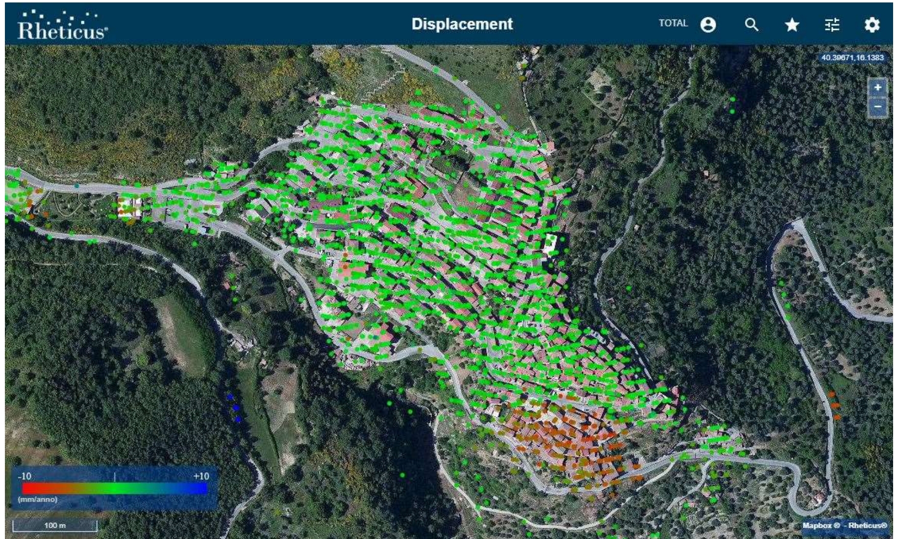
Figura 19: Mappa di velocità media (mm/anno) PS/DS sul centro abitato di Gorgoglione calcolata sul periodo Ottobre 2014 - Giugno 2018. La zona sud del centro abitato presenta una velocità media lungo la LOS pari a circa -6 mm/anno.
