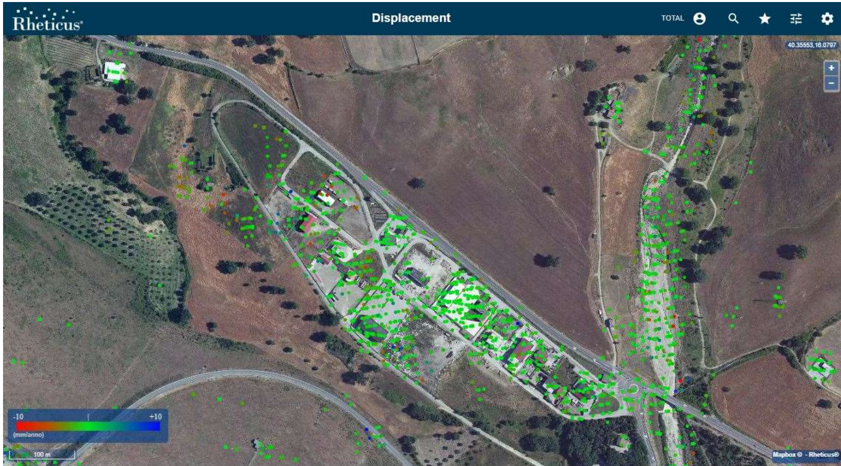
Figura 33: LPG Center caratterizzato da una buona copertura di PS e dai quali si evince una generale stabilità nel periodo Ottobre 2014-Giugno 2018.
