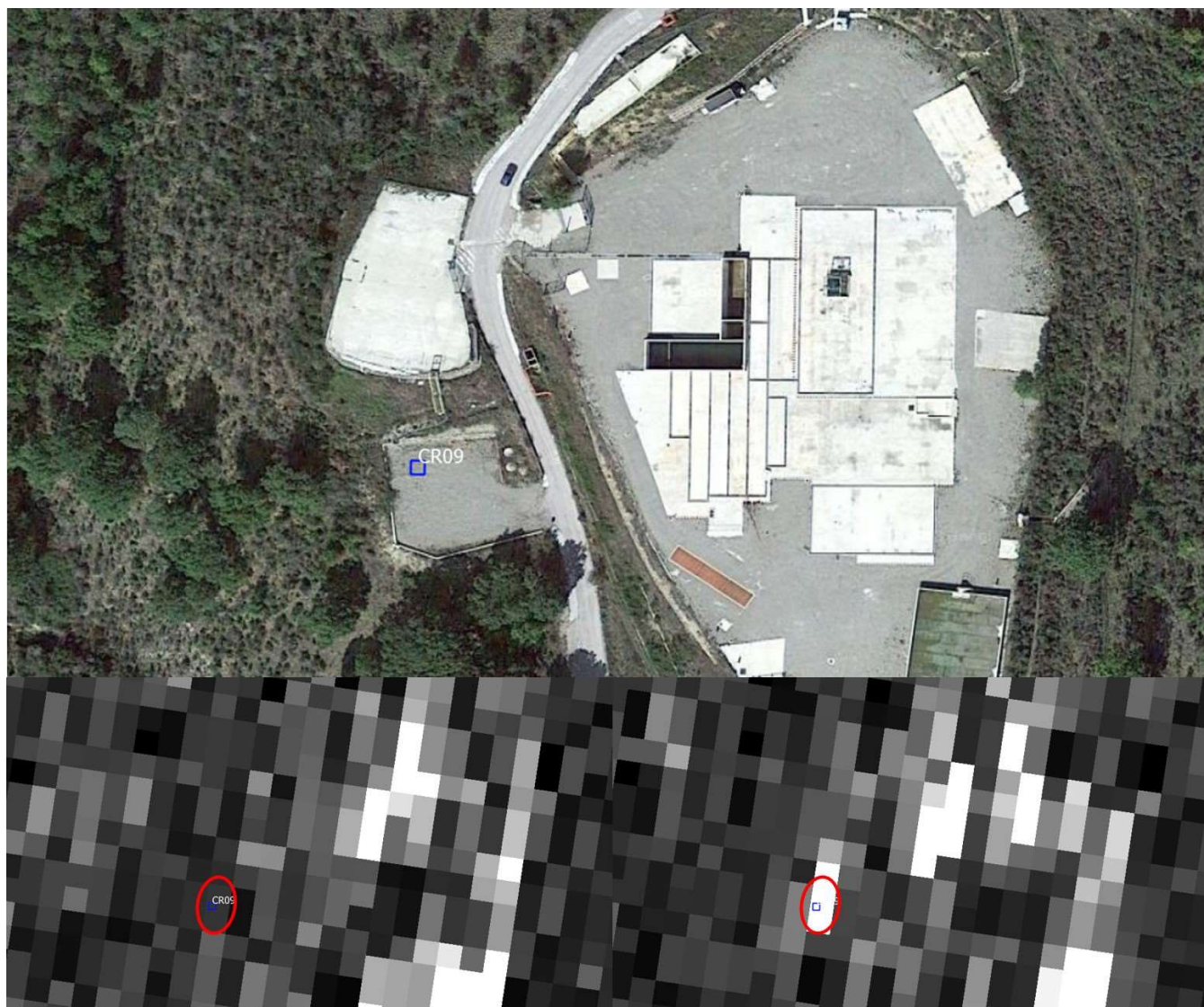
Figura 50: In alto l'immagine con la posizione del CR-09 (quadrato blu) installato a ovest del piazzale TR-2. Dal confronto di intensità sull' orbita Descending pre (immagine in basso a sinistra acquisita il 19 luglio 2018) - post installazione (immagine in basso a destra acquisita il 30 Agosto 2018) si nota un netto miglioramento della risposta in ampiezza sulla zona in prossimità del CR (zona evidenziata dai cerchi rossi).
