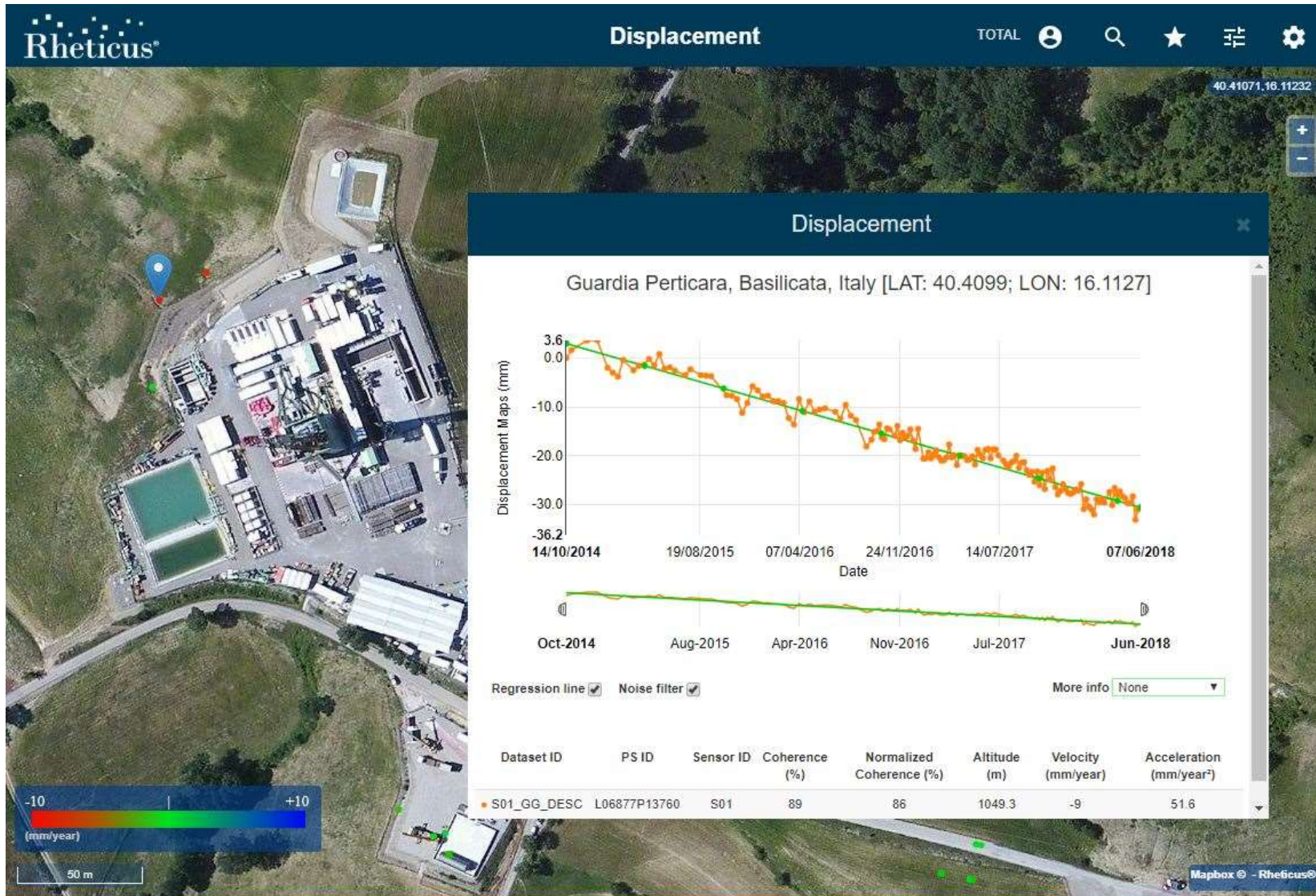
Figura 26: Serie temporale del PS (evidenziato dal puntatore blu nell'immagine) con coerenza 0.89 situato sulla porzione Nord-Ovest in movimento della piazzola del pozzo GG-2 . La velocità media del PS sul periodo Ottobre 2014 – Giugno 2018 è pari a -9 mm/anno.
