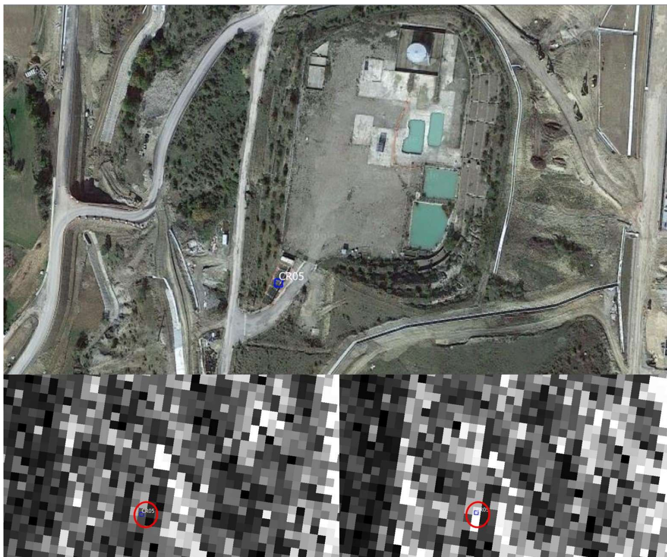
Figura 43: In alto l'immagine con la posizione del CR-05 (quadrato blu) installato nella zord sud del piazzale GG-1. Dal confronto di intensità sull' orbita Ascending pre (immagine in basso a sinistra acquisita il 20 luglio 2018) - post installazione (immagine in basso a destra acquisita il 31 Agosto 2018) si nota un netto miglioramento della risposta in ampiezza sulla zona in prossimità del CR (zona evidenziata dai cerchi rossi).
