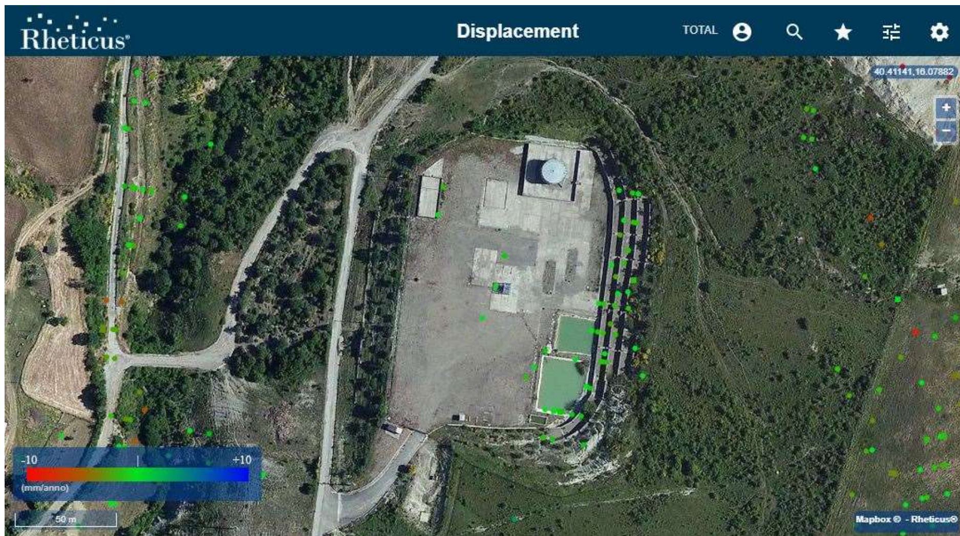
Figura 24: Pozzo GG-1 caratterizzato da una buona copertura di PS e dai quali si evince una generale stabilità nel periodo Ottobre 2014-Giugno 2018.
