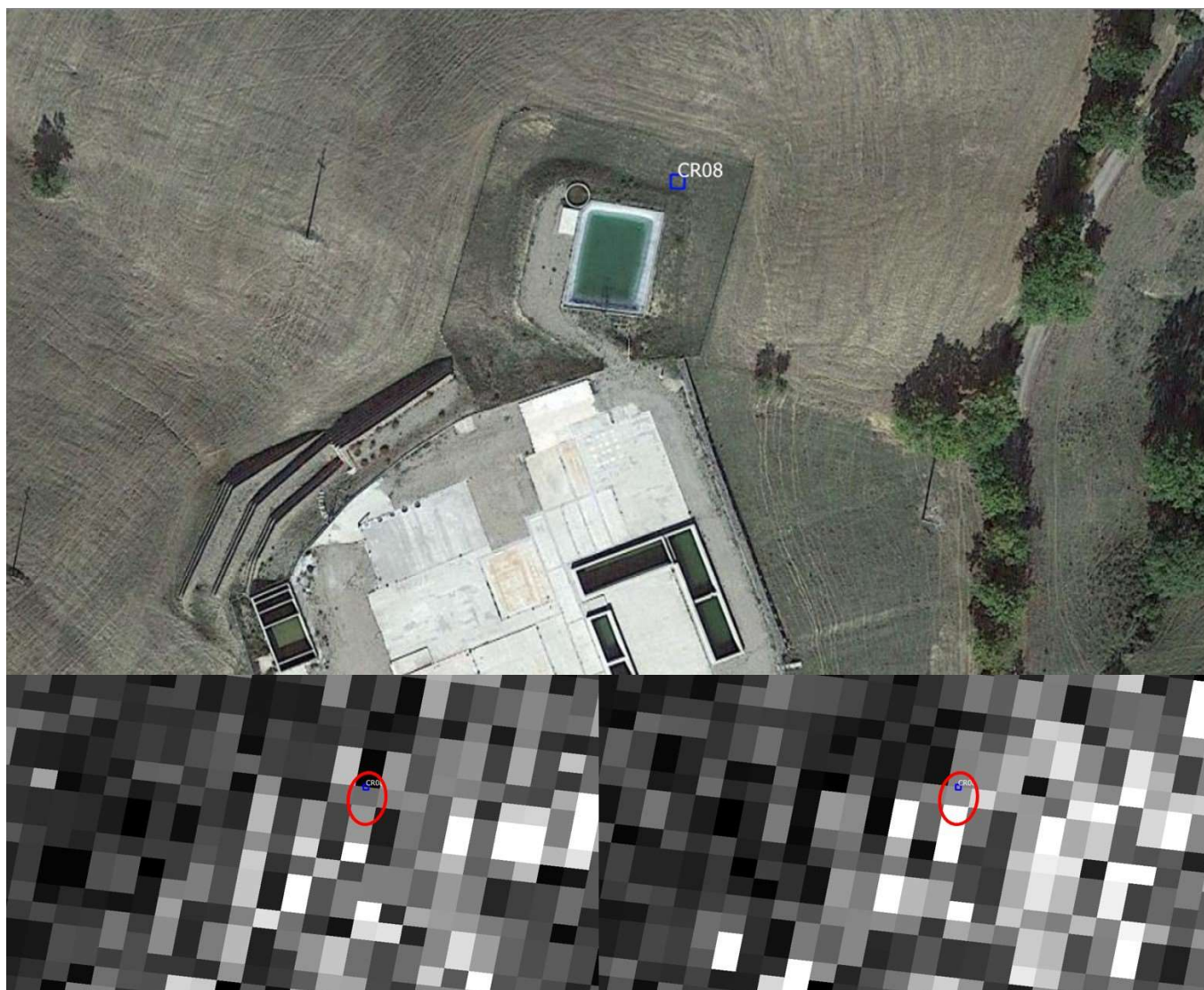
Figura 48 In alto l'immagine con la posizione del CR-08 (quadrato blu) installato nella zord nord del piazzale GG-2. Dal confronto di intensità sull' orbita Descending pre (immagine in basso a sinistra acquisita il 19 luglio 2018) - post installazione (immagine in basso a destra acquisita il 18 Agosto 2018) si nota un netto miglioramento della risposta in ampiezza sulla zona in prossimità del CR (zona evidenziata dai cerchi rossi).
