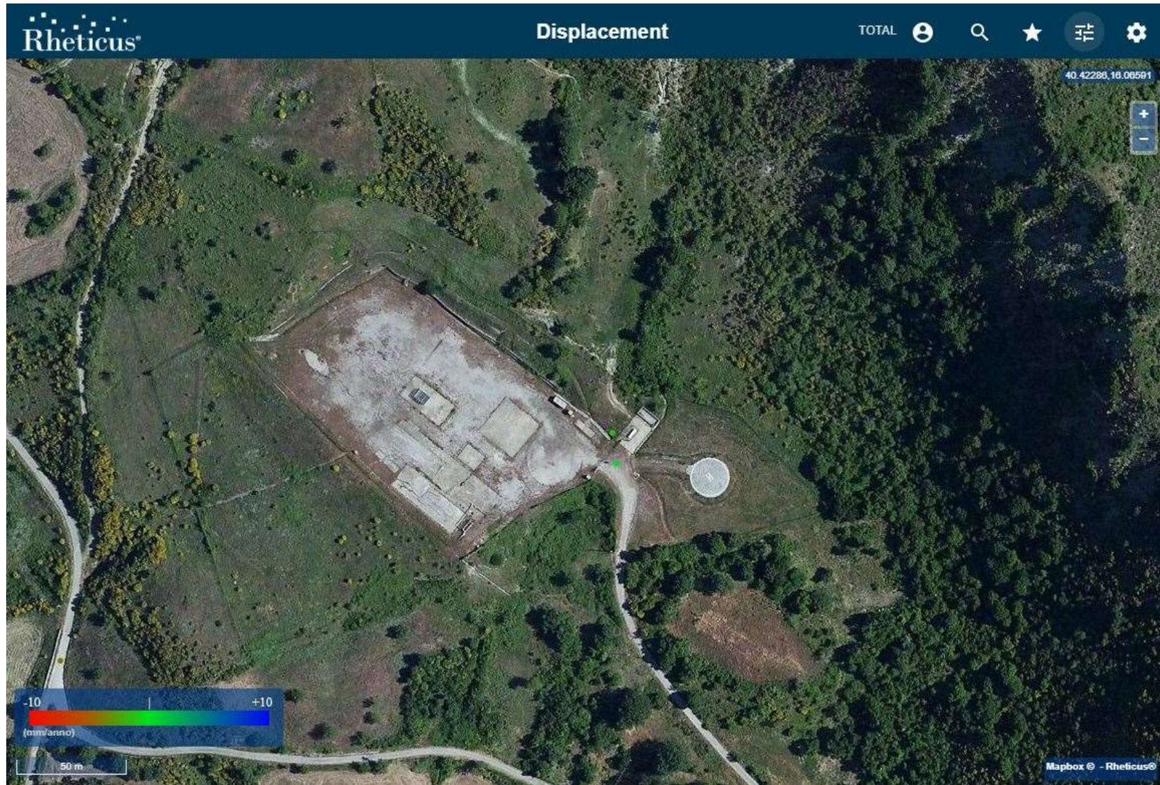
Figura 30: Pozzo TR-1 sulla cui piazzola solo stati individuati 2 PS che mostrano una situazione di stabilità nel periodo Ottobre 2014-Giugno 2018.
