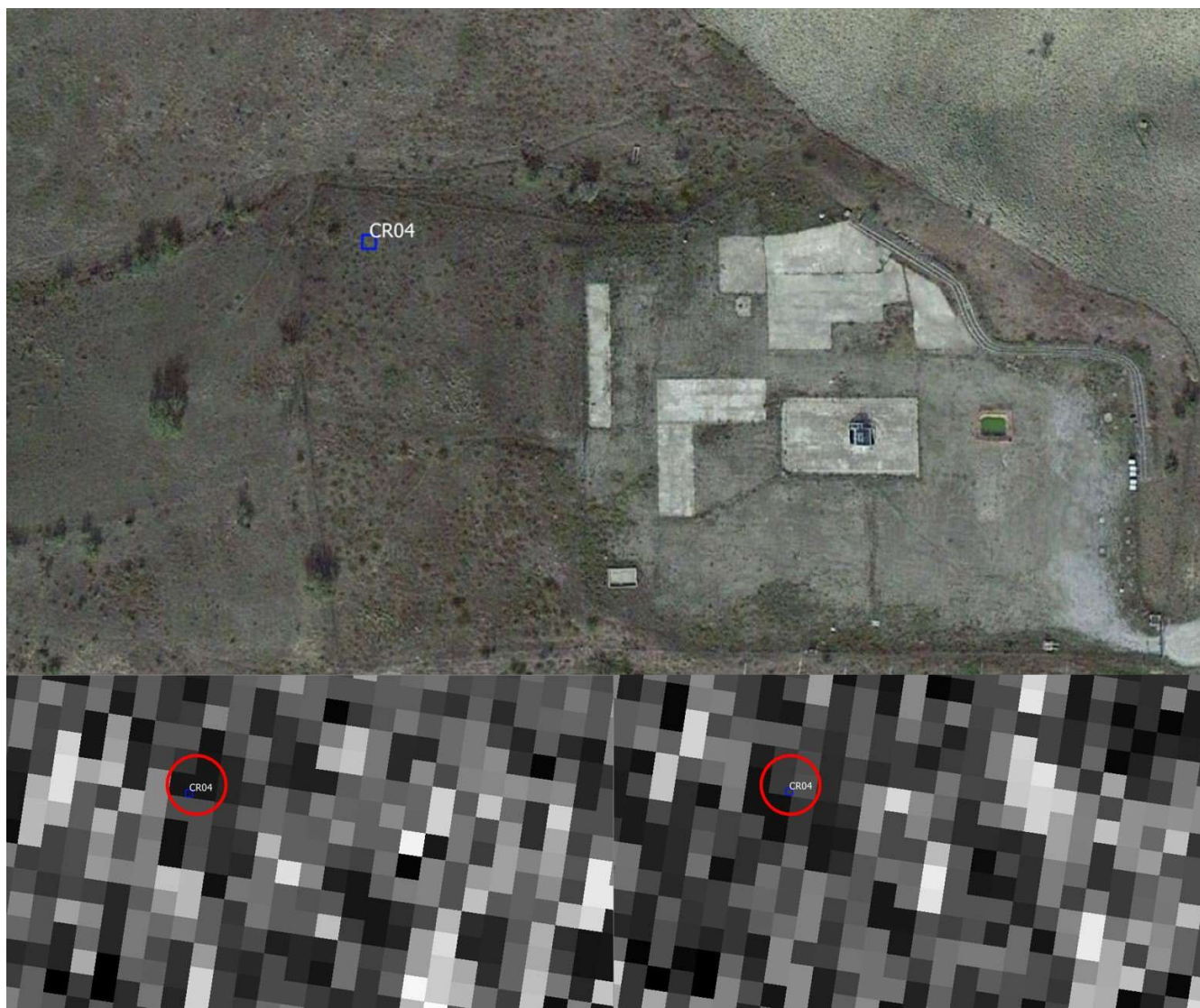
Figura 41: : In alto l'immagine con la posizione del CR-04 (quadrato blu) installato ad ovest del piazzale PT-1. Dal confronto di intensità sull' orbita Ascending pre (immagine in basso a sinistra acquisita il 14 luglio 2018) - post installazione (immagine in basso a destra acquisita il 31 Agosto 2018). La risposta in ampiezza rispetto all'orbita ascending non è sufficiente per poter confermare la visibilità del CR (zona evidenziata dai cerchi rossi). Richiede una verifica dell'orientamento e di possibili ostacoli che potrebbero impedire la visibilità satellitare (recinzione, tralicci etc).
