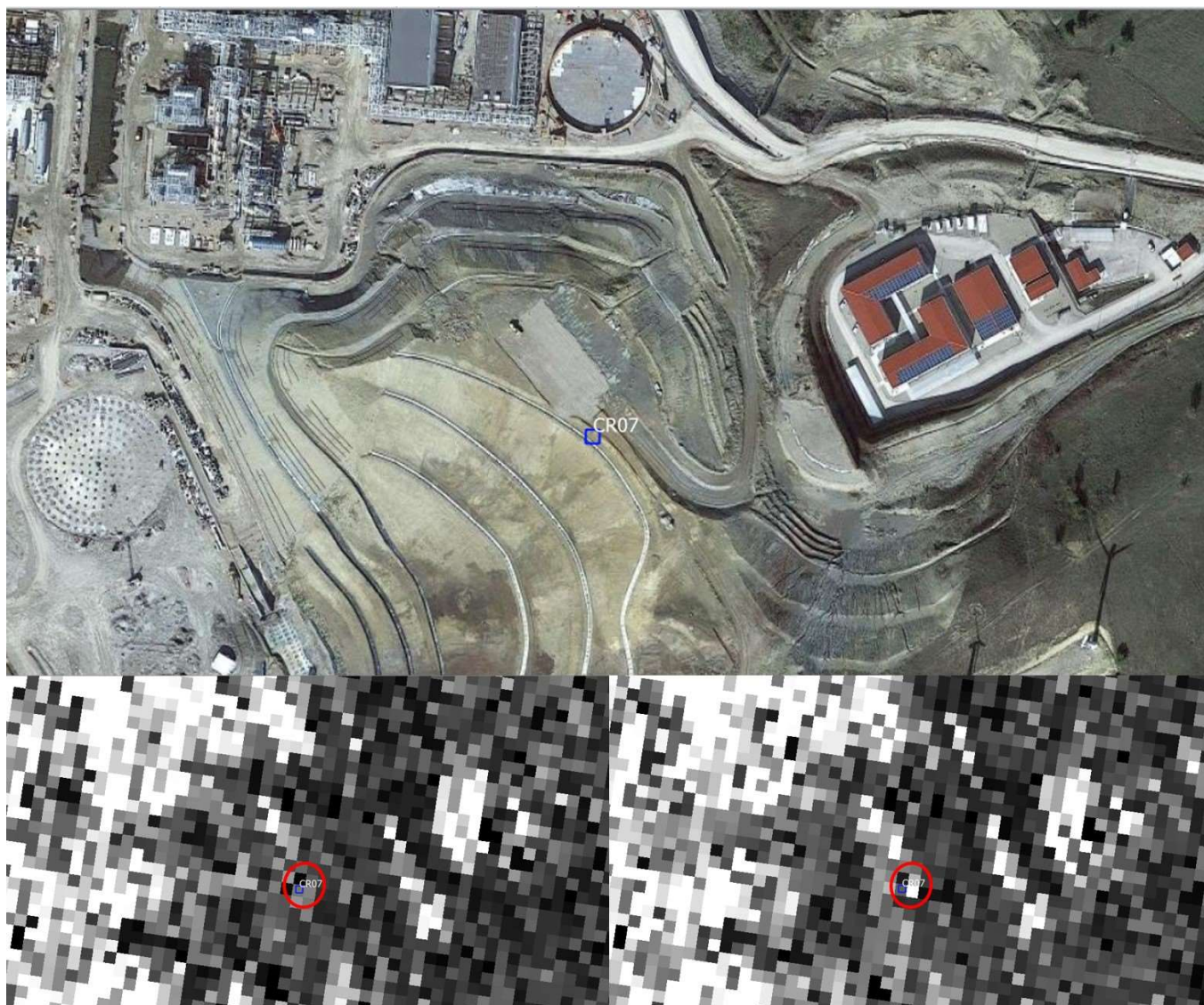
Figura 45: In alto l'immagine con la posizione del CR-07(quadrato blu) installato nei pressi dell' Oil Center . Dal confronto di intensità sull' orbita Ascending pre (immagine in basso a sinistra acquisita il 14 luglio 2018) - post installazione (immagine in basso a destra acquisita il 31 Agosto 2018) si nota un netto miglioramento della risposta in ampiezza sulla zona in prossimità del CR (zona evidenziata dai cerchi rossi).
