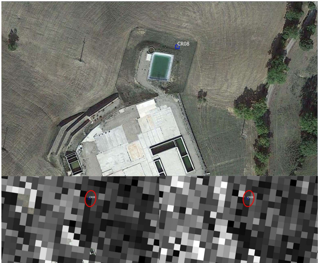
Figura 47: In alto l'immagine con la posizione del CR-08 (quadrato blu) installato nella zord nord del piazzale GG-2. Dal confronto di intensità sull' orbita Ascending pre (immagine in basso a sinistra acquisita il 14 luglio 2018) - post installazione (immagine in basso a destra acquisita il 31 Agosto 2018). La risposta in ampiezza rispetto all'orbita ascending non è sufficiente per poter confermare la visibilità del CR (zona evidenziata dai cerchi rossi). Richiede una verifica dell'orientamento e presenza di possibili ostacoli che potrebbero impedire la visibilità satellitare (recinzione, tralicci etc).
