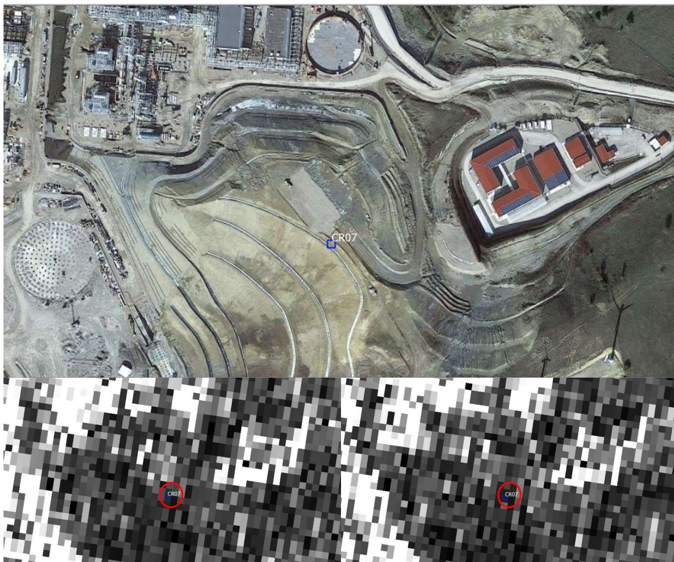
Figura 46: In alto l'immagine con la posizione del CR-07(quadrato blu) installato nei pressi dell'Oil Center. Dal confronto di intensità sull'orbita Descending pre (immagine in basso a sinistra acquisita il 19 luglio 2018) - post installazione (immagine in basso a destra acquisita il 30 Agosto 2018) sulla zona in prossimità del CR (zona evidenziata dai cerchi rossi) non sembra esserci nessun miglioramento in termini di risposta in ampiezza pertanto il CR potrebbe non essere visibile rispetto all'orbita descending.
