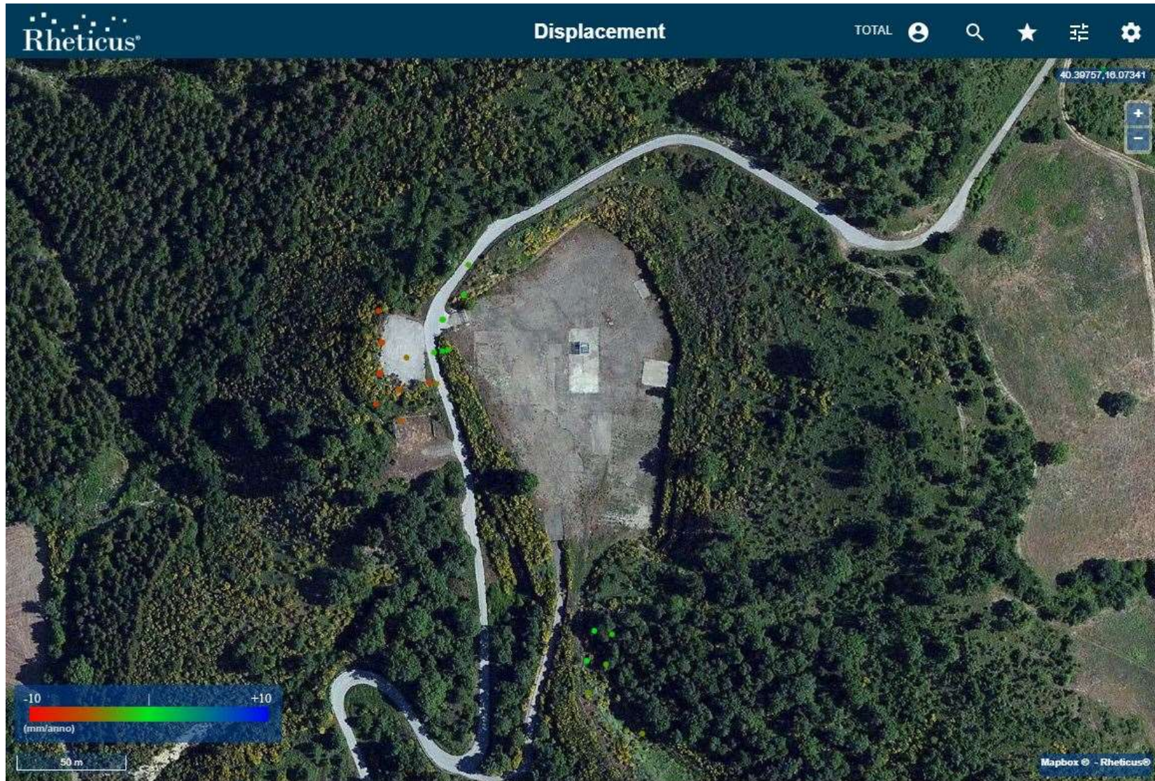
Figura 31: Pozzo TR-2 dove i PS presenti sulla piazzola mostrano una situazione di stabilità mentre il piazzale situato ad ovest mostra una velocità media pari a circa -6 mm/anno nel periodo Ottobre 2014 - Giugno 2018.
