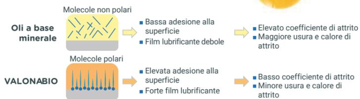
**Valona BIO** può essere utilizzato nei sistemi di lubrificazione minima (MQL)
