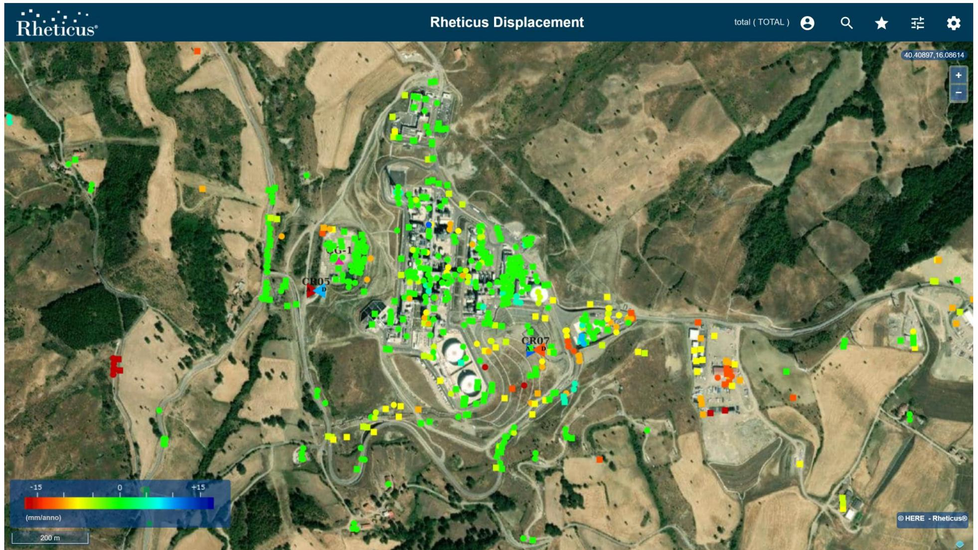
Figura 33: Oil Center caratterizzato da una buona copertura di PS e dai quali nel periodo esteso a Dicembre 2021, non si evincono variazioni significative di velocità media rispetto al precedente rapporto [RD11].
