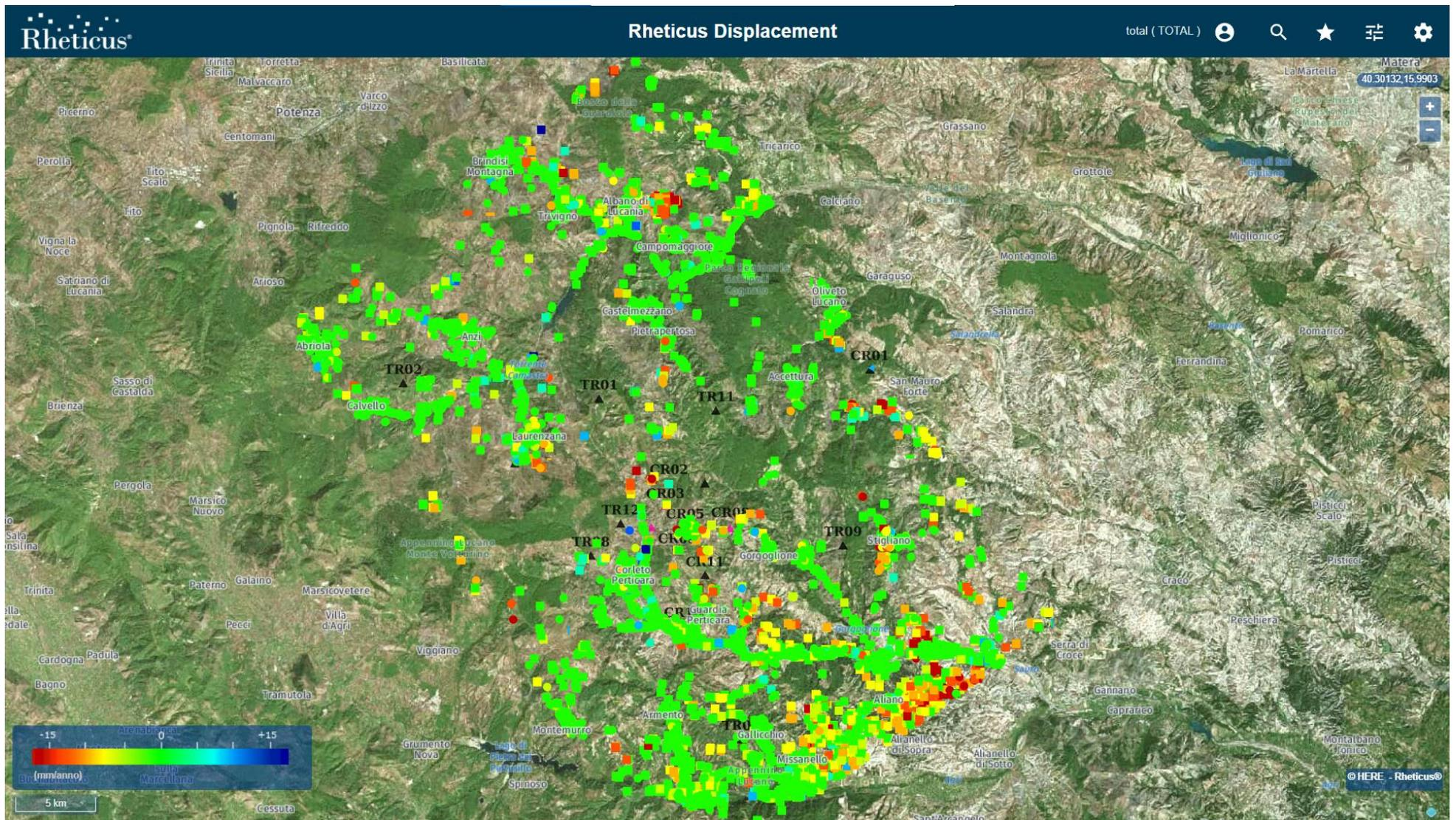
Figura 4: Mappa velocità media annua (mm/anno) lungo la LOS sul periodo esteso a Dicembre 2021 ottenuta dal processamento del dataset Sentinel-1 in orbita descending.
