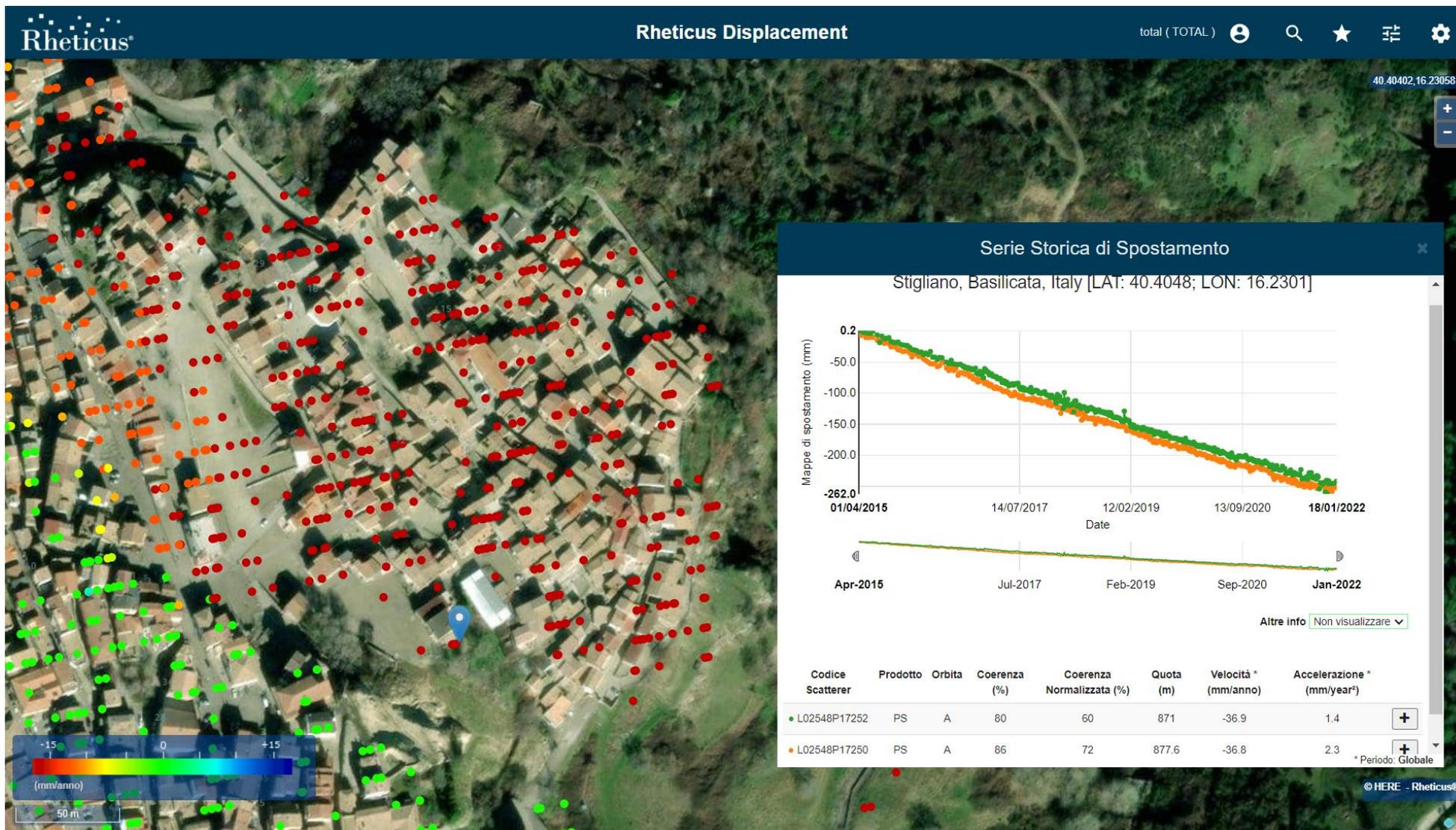
Figura 10: Visualizzazione dei soli PS/DS caratterizzati da una velocità media di abbassamento superiore a -20 mm/anno. Il grafico mostra le serie temporali di 3 PS (evidenziati dal puntatore blu nell'immagine – CODE: L02548P17250, L02548P17252) a più alta velocità situato nella zona Nord-Est del centro abitato di Stigliano caratterizzato da una velocità media in orbita Ascending pari a circa -37 mm/anno in linea con quanto misurato nel precedente rapporto [RD11].
