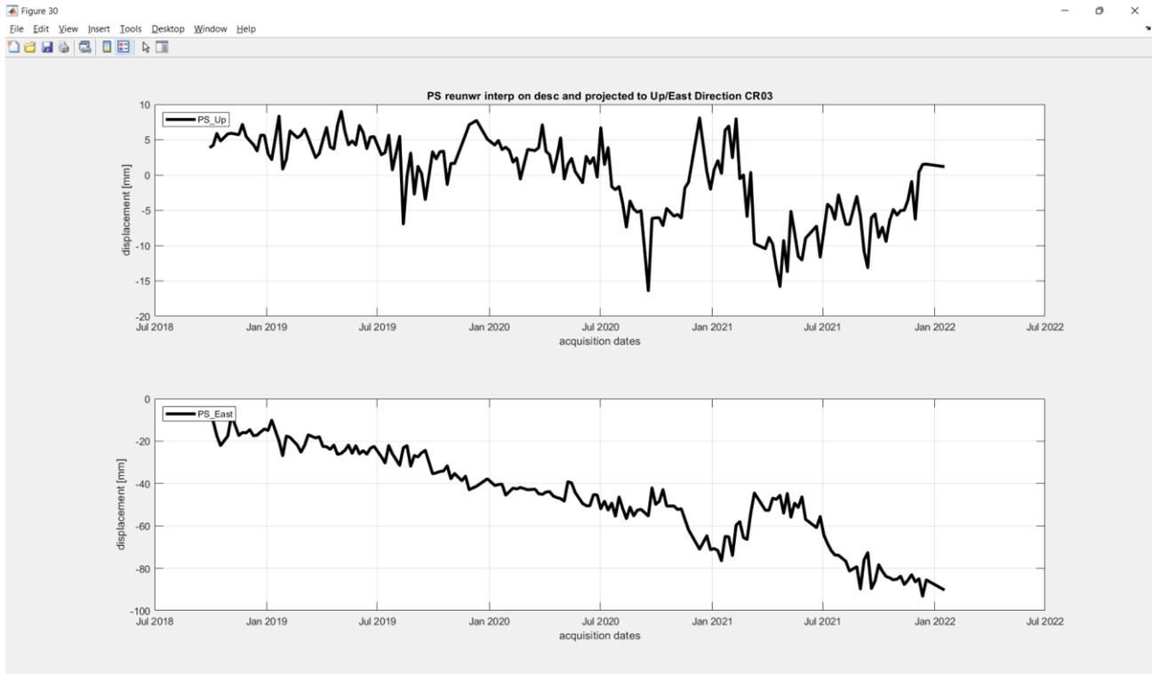
Figura 26: il grafico in alto rappresenta la serie temporale di spostamento in direzione Verticale (PS\_Up) mentre il grafico in basso rappresenta la serie temporale di spostamento in direzione est (PS\_Est).
