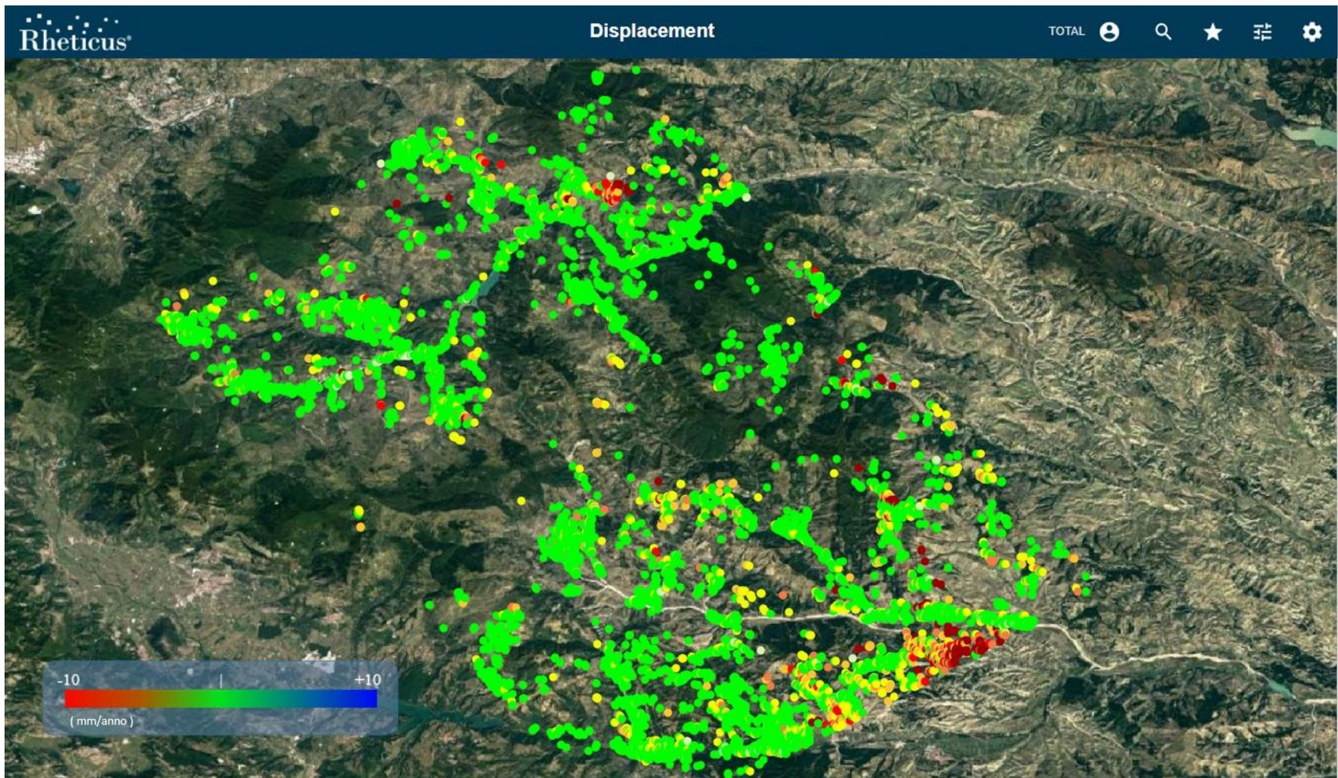
Figura 5: Mappa velocità media annua (mm/anno) lungo la direzione verticale sul periodo esteso a Dicembre 2021 ottenuta dalla combinazione delle immagini Ascending e Descending acquisite dal satellite Sentinel-1.
