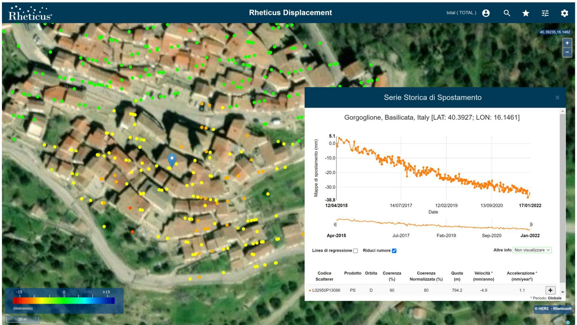
Figura 8: Serie temporale del PS (evidenziato dal puntatore blu nell'immagine) ad alta coerenza (0.90) situato al centro dell'area in movimento del centro abitato di **Gorgoglione**. La velocità media del PS sul periodo esteso a Dicembre 2021 è pari a -4.9 mm/anno in linea con quanto misurato nel precedente rapporto [RD11].
