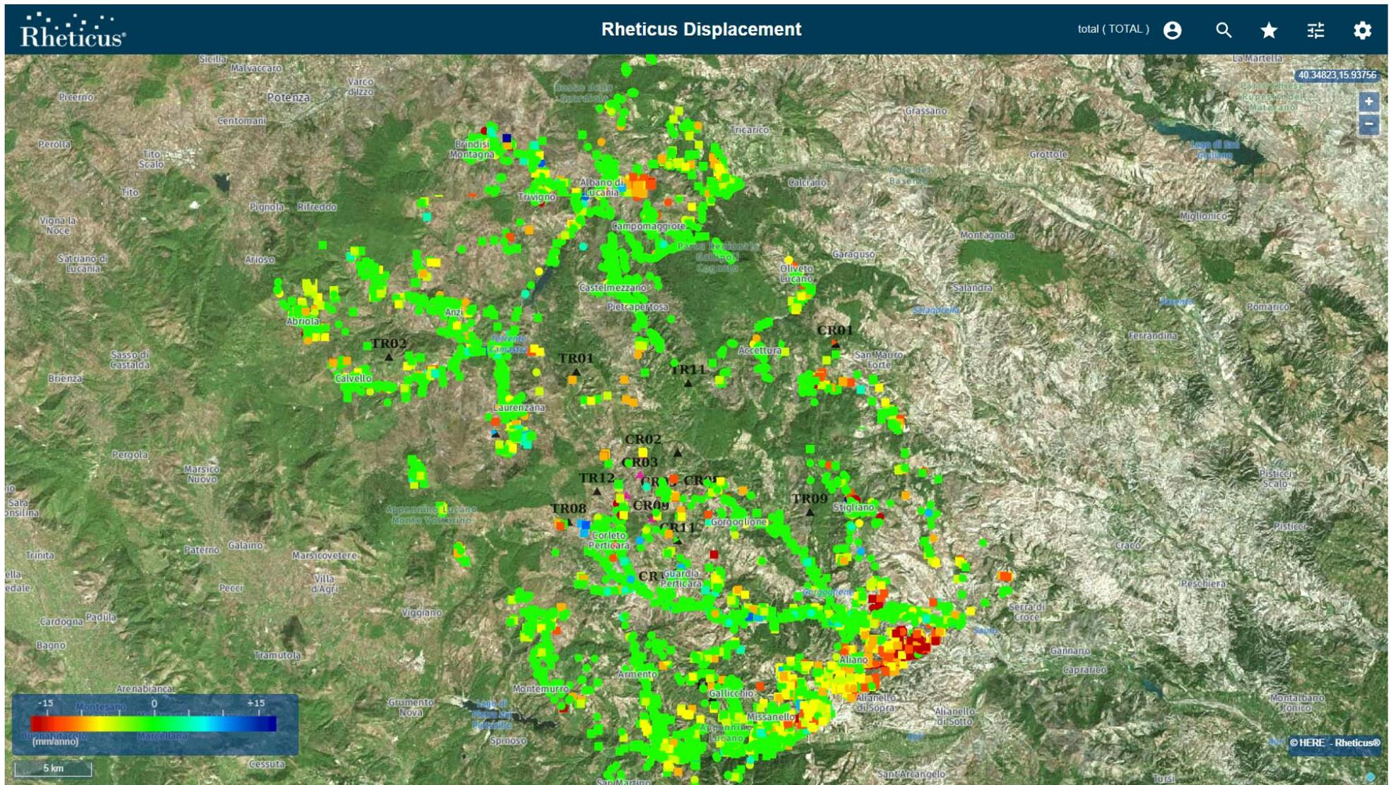
Figura 3: Mappa velocità media annua (mm/anno) lungo la LOS sul periodo esteso a Dicembre 2021 ottenuta dal processamento del dataset Sentinel-1 in orbita ascending.
