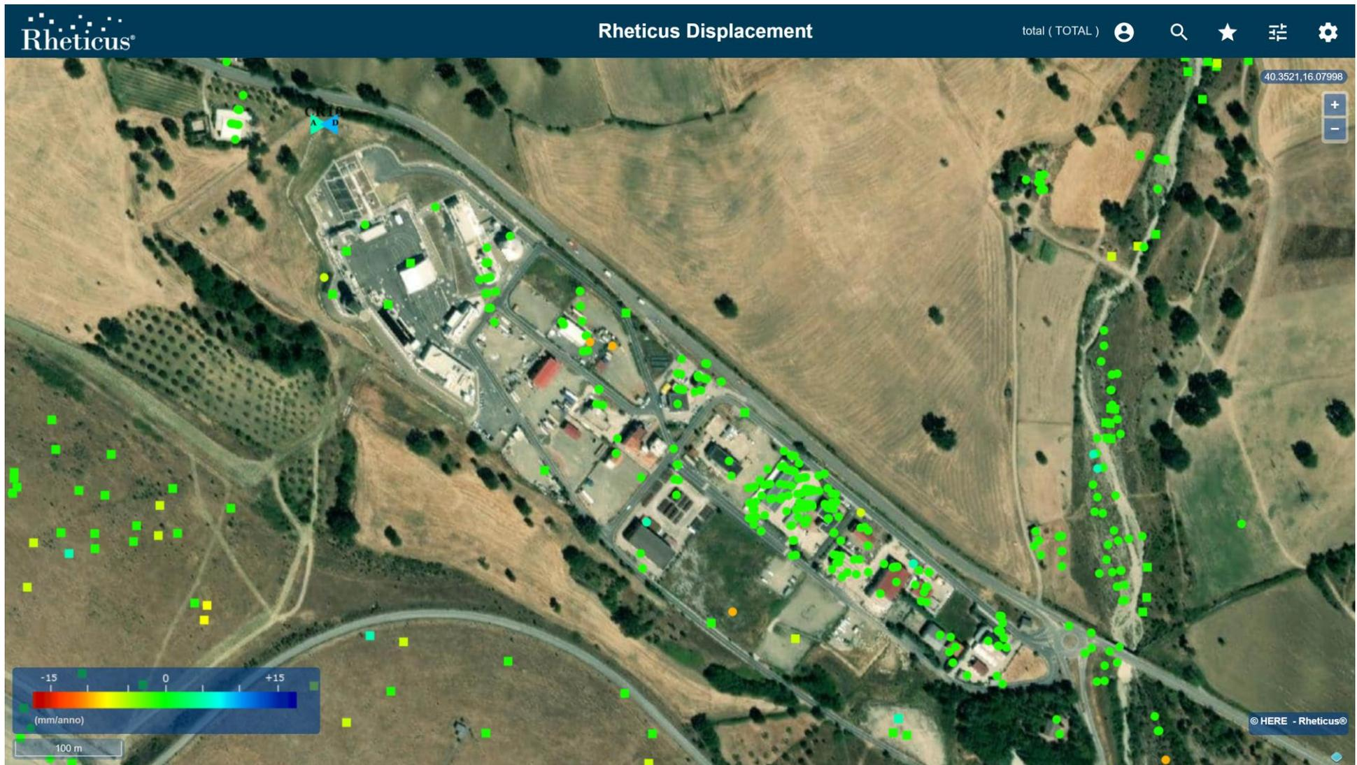
Figura 30: **LPG Center** caratterizzato da una buona copertura di PS e dai quali nel periodo esteso a Dicembre 2021, non si evincono variazioni significative di velocità media rispetto al precedente rapporto [RD11][RD10] .
