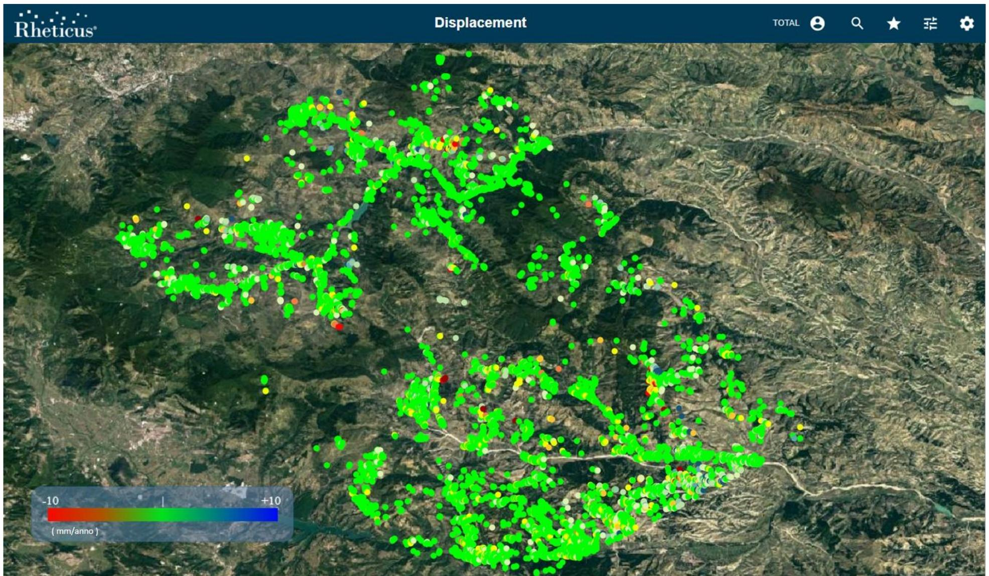
Figura 6: Mappa velocità media annua (mm/anno) in direzione Est(+) - Ovest(-) sul periodo esteso a Dicembre 2021 ottenuta dalla combinazione delle immagini Ascending e Descending acquisite dal satellite Sentinel-1.
