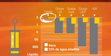
Estabilidad mecánica en presencia de agua (ASTM D217)
