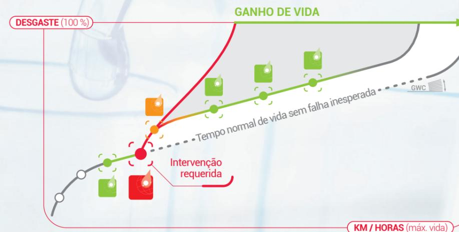
O **Coefficiente de Desgaste Geral (GWC)** normalmente aumenta o ciclo de vida do veículo ou máquina.
