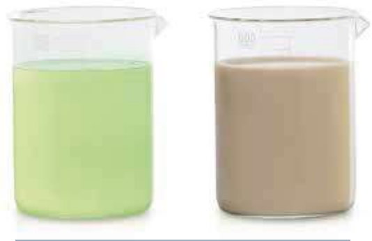
Comparación entre la apariencia de TotalEnergies Folia y un fluido basado en aceite tras el mecanizado
