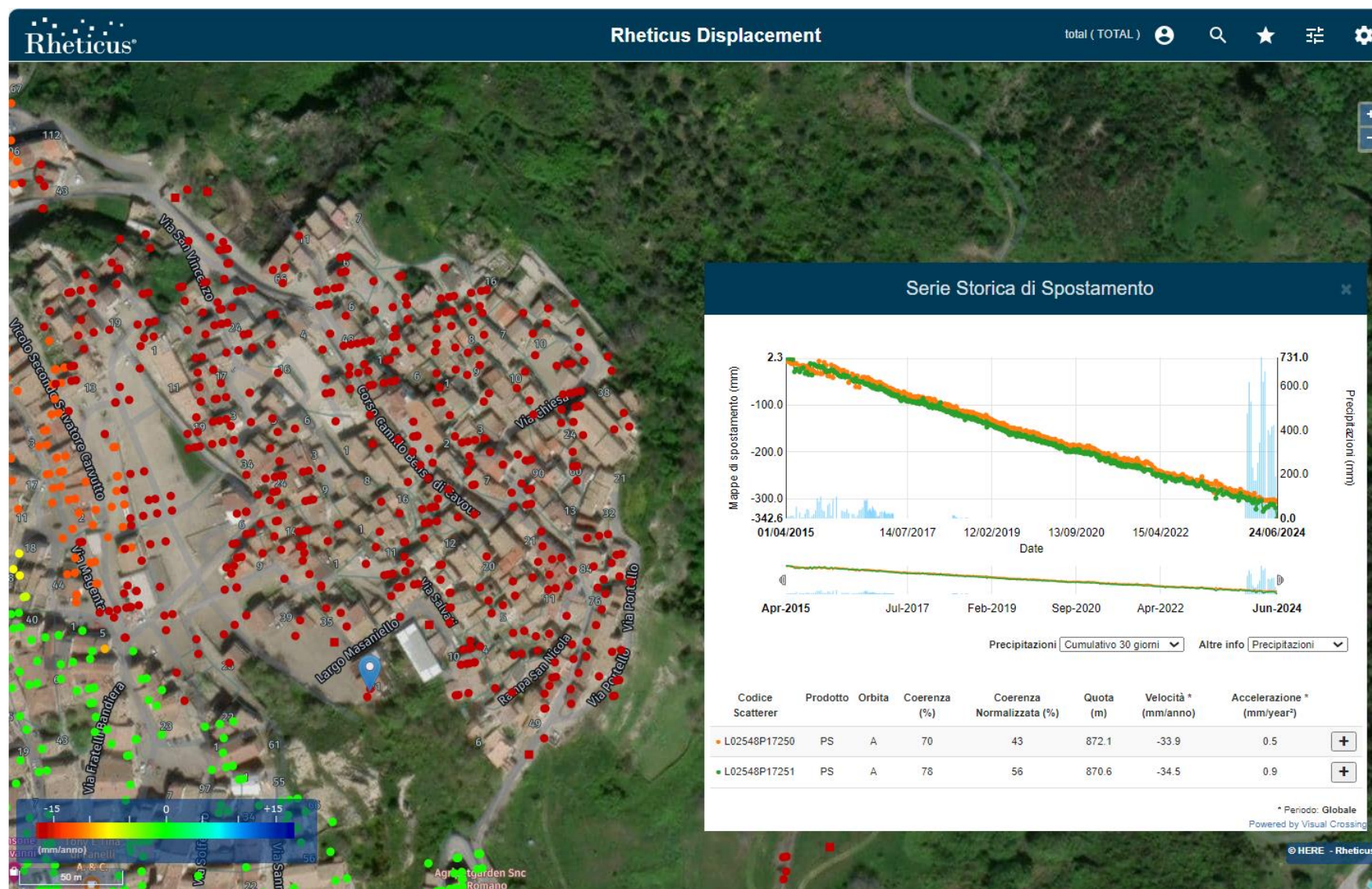
Figura 10: Visualizzazione dei soli PS/DS caratterizzati da una velocità media di abbassamento superiore a -20 mm/anno. Il grafico mostra le serie temporali di 2 PS (evidenziati dal puntatore blu nell'immagine – CODE: L02548P17250, L02548P17251) a più alta velocità situato nella zona Nord-Est del centro abitato di Stigliano caratterizzato da una velocità media in orbita Ascending pari a circa -35 mm/anno in linea con quanto misurato nel precedente rapporto [RD16].
