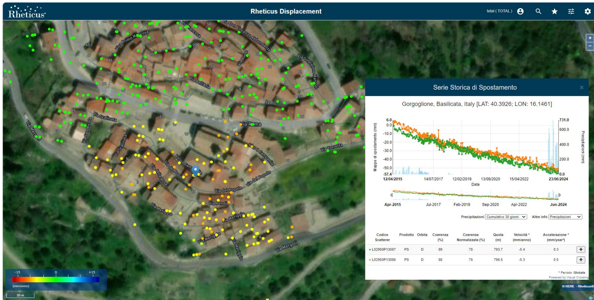
Figura 8: Serie temporale del PS (evidenziato dal puntatore blu nell'immagine) ad alta coerenza (0.88) situato al centro dell'area in movimento del centro abitato di Gorgoglione . La velocità media del PS sul periodo esteso a Giugno 2024 è pari a -5.3 mm/anno in linea con quanto misurato nel precedente rapporto [RD16].
