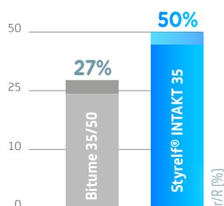
Résistance au gazole sur éprouvette Duriez 24h (formule ouverte 10%)
