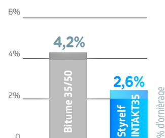
Essai réalisé à 30 000 cycles selon la norme NF EN 12697-22
