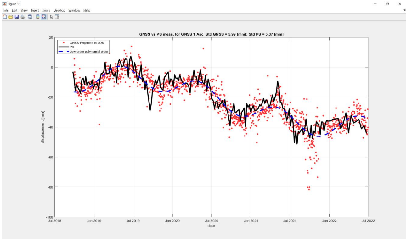
Figura 45: la figura rappresenta il confronto quantitativo effettuato in geometria SAR Ascending tra le misure GNSS (punti rossi) e SAR (linea nera) in corrispondenza del CR01. La linea blu tratteggiata rappresenta il fit polinomiale stimato sui dati GNSS. Il trend delle serie temporali GNSS e SAR e le relative deviazioni standard confermano un ottimo accordo anche a livello quantitativo.
