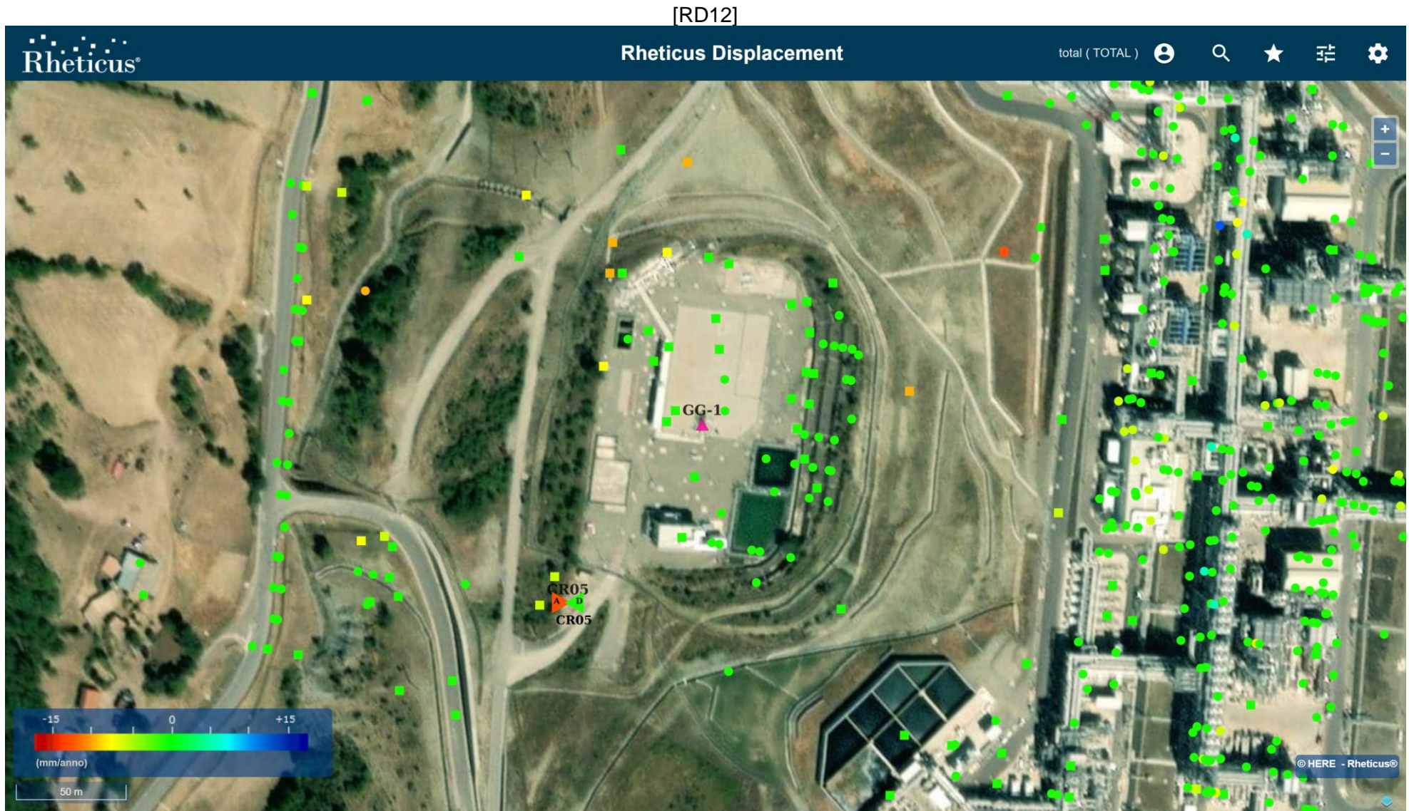
Figura 12: Pozzo GG-1 (indicato dal triangolo fucsia) caratterizzato da una buona copertura di PS e dai quali, nel periodo esteso a Giugno 2022, non si evincono variazioni significative di velocità media rispetto al precedente rapporto [RD12].
