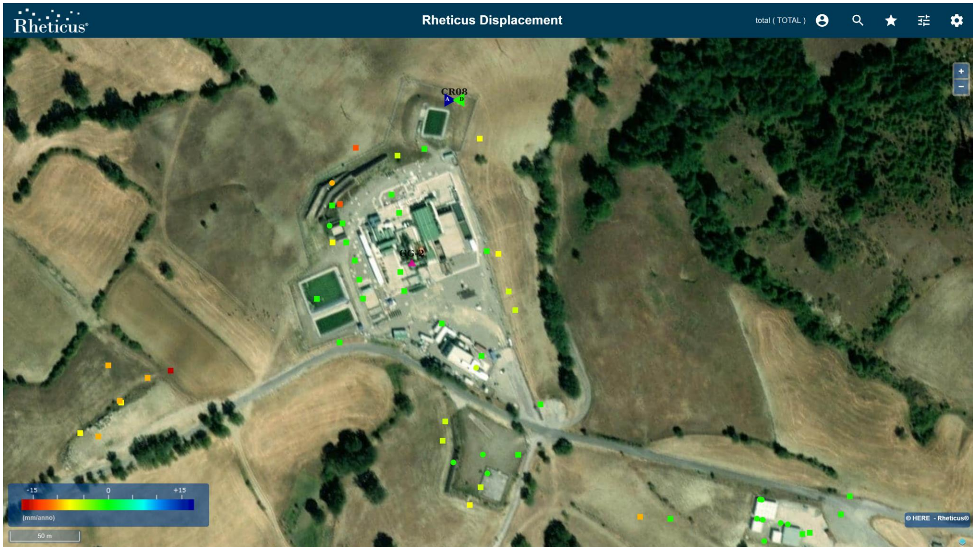
Figura 15: Pozzo GG-2 (indicato dal triangolo fucsia) caratterizzato da una buona copertura di PS e dai quali, nel periodo esteso a Giugno 2022, non si evincono variazioni significative di velocità media rispetto al precedente rapporto [RD12].
