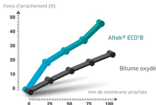
L'adhésivité d'une membrane d'étanchéité collée sur support aluminium avec Altek® ECO<sup>2</sup>B est plus forte comparée aux bitumes oxydés.
