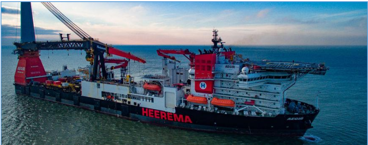
Figura 4.5.4.7.1 Buque de construcción de aguas profundas Aegir ( www.heerema.com/fleet/aegir )
