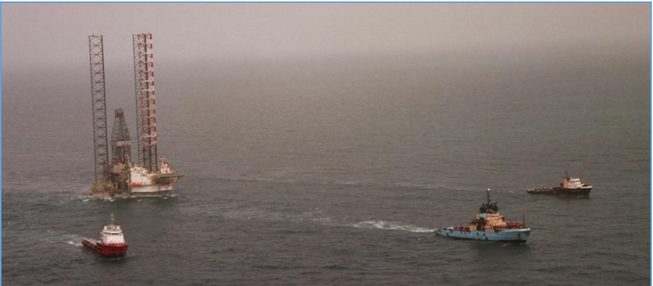
Figura 4.5.3.2.1 Plataforma del tipo Jack-up remolcada por 3 remolcadores frente a las costas de Tierra del Fuego. Fuente: Total Austral.
