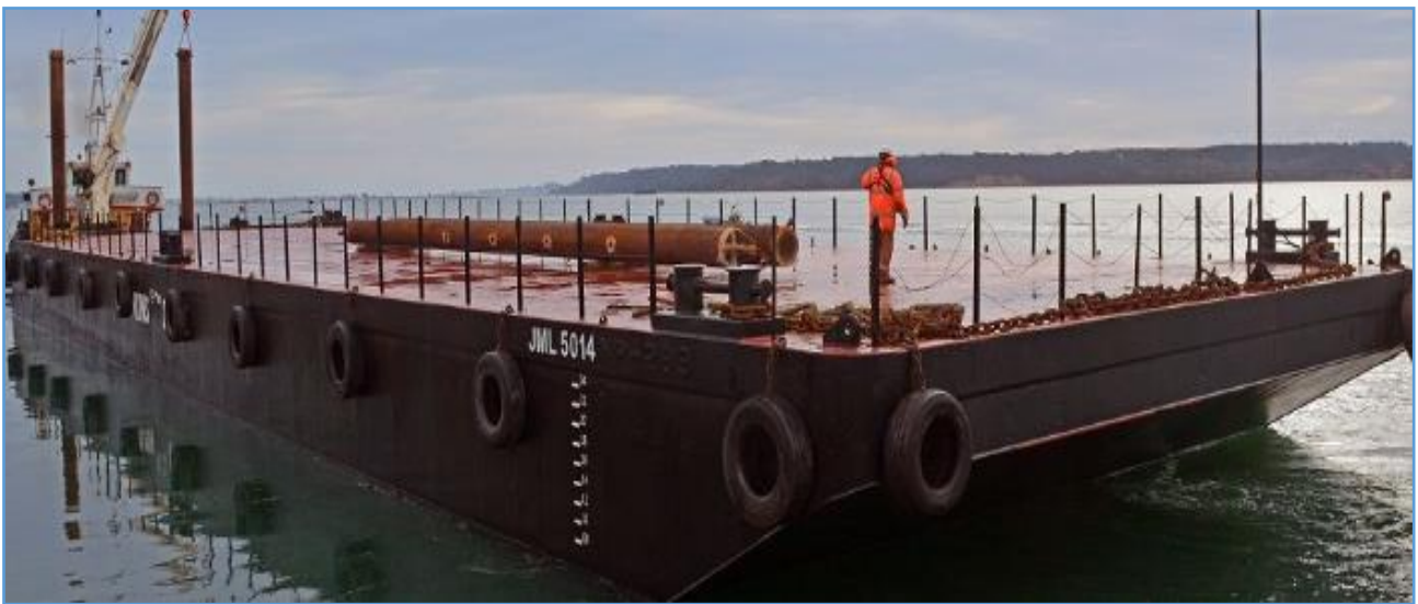
Figura 4.5.2.4.1 Barcaza de piso plano, tipo pontón, sin propulsión propia.
