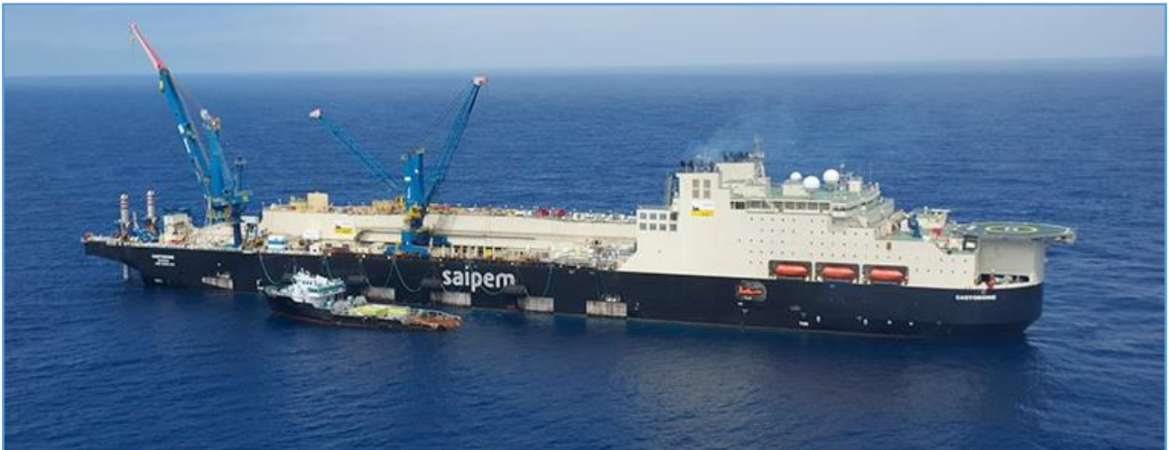
Figura 4.5.4.1.1 Buque para el tendido de tuberías submarinas Castorone y buque de soporte ( www.saipem.com/en/identity-and-vision/assets/castorone )
