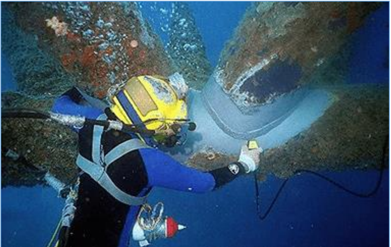
Figura 4.9.2.2.1 Inspección mediante ACFM
