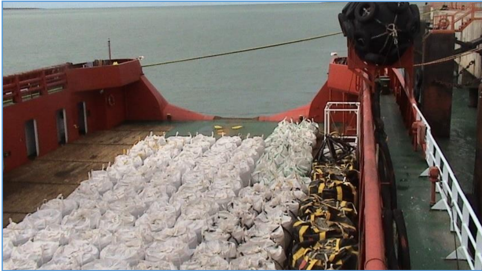
Figura 4.9.2.7.2 Remediación de zonas libres de apoyo (Remote Operated Vehicle, ROV).
