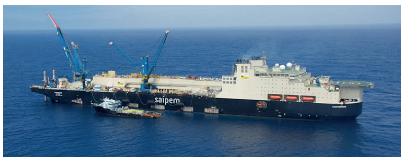
Figura 2.1.5 Buque para el tendido de tuberías submarinas Castorone y buque de soporte Fuente: www.saipem.com
