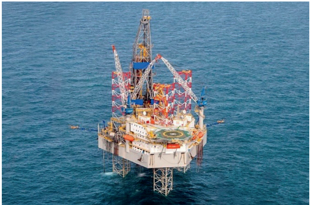
Figura 2.1.3 Plataforma Jack Up Noble Houston Colbert utilizada para la perforación de pozos Vega Pléyade Fuente: www.noblecorp.com
