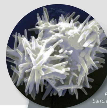
Estructura cálcica cristalina similar a un patrón «escama de pez»/oblea de tamaño nanométrico paralelo a la superficie metálica lubricada
