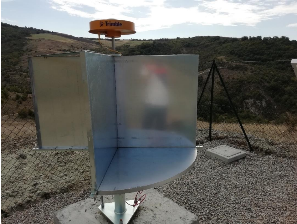
Figura 2 – Antenna Choke Ring installata al centro di un corner reflector.
