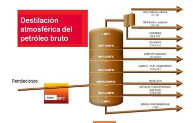
Este residuo atmosférico se somete entonces a la segunda etapa de fabricación: la destilación al vacío.
