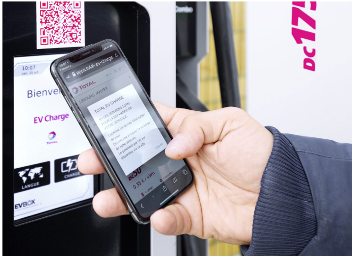
Application smartphone permettant de piloter la recharge d'un véhicule électrique.
