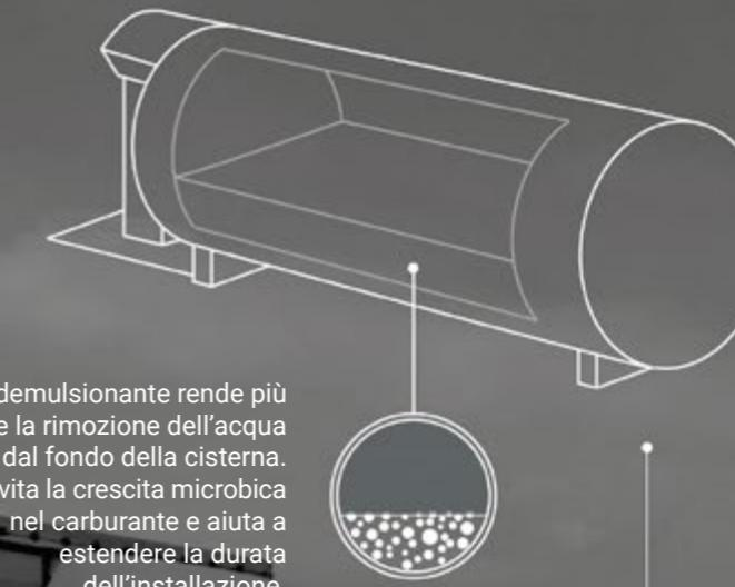
Il demulsionante rende più semplice la rimozione dell'acqua dal fondo della cisterna. Questo evita la crescita microbica nel carburante e aiuta a estendere la durata dell'installazione.
