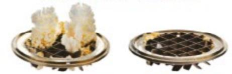
(1) Vista di un risciacquo SCR senza uso di ClearNOx® o con uso di ClearNOx®. Test effettuati su un veicolo diverso di fabbricazione a 20°C (alternativo SCR), Ossido Nitroso TotalEnergies (totale).
