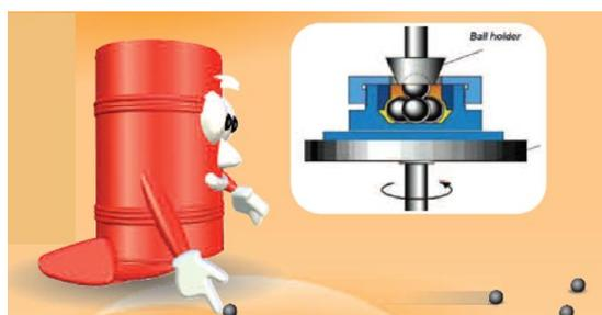
velocidades lentas y altas cargas. La función de un aditivo de extrema presión (EP) es la de proteger los componentes cuando la viscosidad del aceite no es suficiente para suministrar un espesor de película adecuado.
