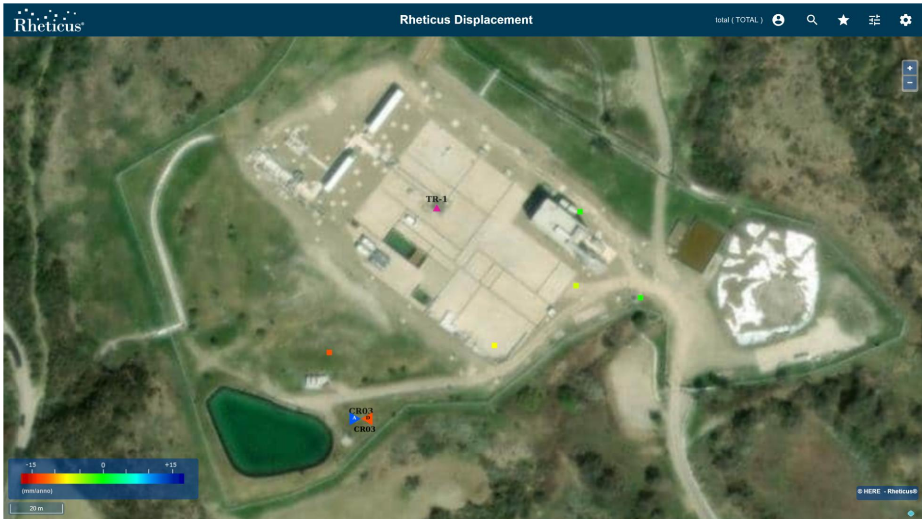
Figura 24: Pozzo TR-1 (indicato dal triangolo fucsia) Nel periodo esteso a Dicembre 2022, non si evincono variazioni significative di velocità media rispetto al precedente rapporto [RD13]. Dai PS verdi presenti si evince come la parte est della piazzola non è influenzata dal fenomeno franoso situato a monte della stessa.
