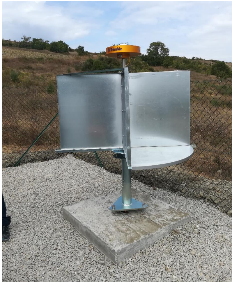
Figura 38: Foto di uno dei corner reflectors su cui è montata la stazione GNSS. L'altezza delle pareti del corner reflector è di 70 cm.
