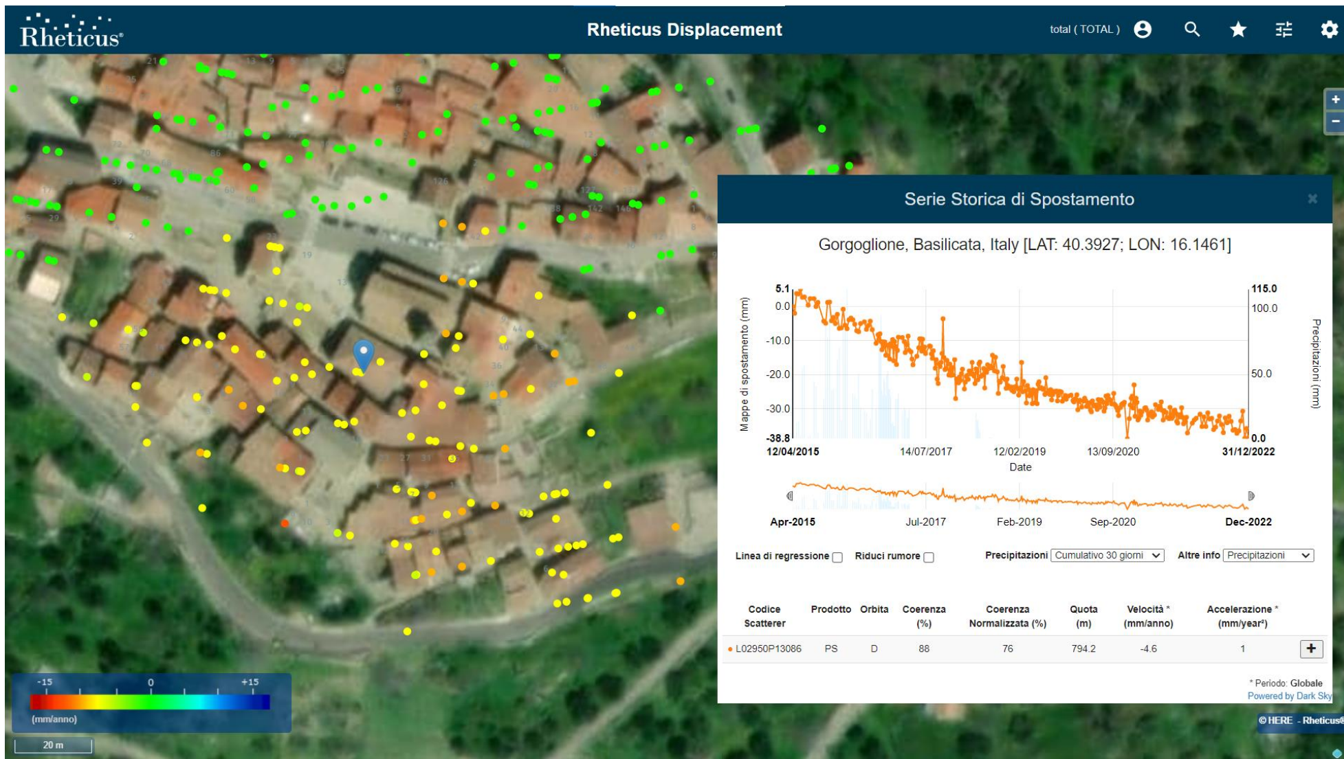
Figura 8: Serie temporale del PS (evidenziato dal puntatore blu nell'immagine) ad alta coerenza (0.88) situato al centro dell'area in movimento del centro abitato di Gorgoglione . La velocità media del PS sul periodo esteso a Dicembre 2022 è pari a -4.6 mm/anno in linea con quanto misurato nel precedente rapporto [RD13].
