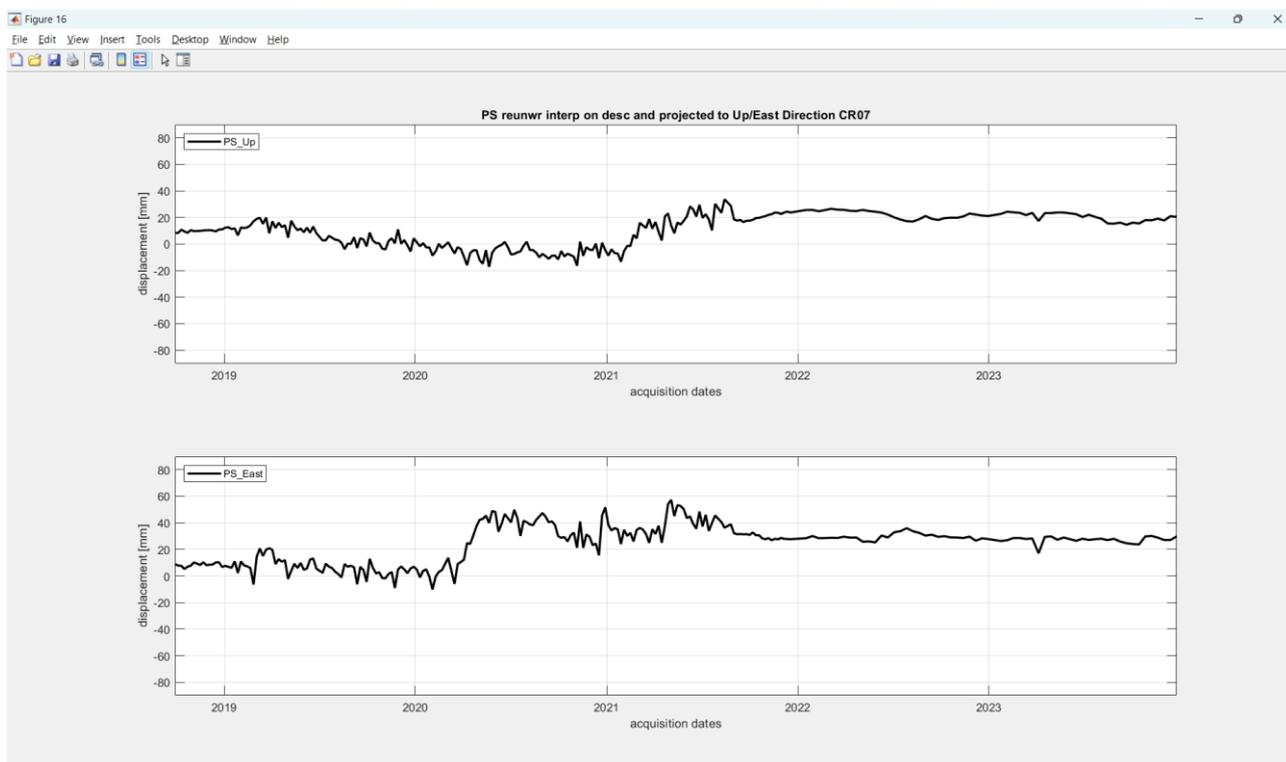
Figura 35: il grafico in alto rappresenta la serie temporale di spostamento in direzione Verticale (PS\_Up) mentre il grafico in basso rappresenta la serie temporale di spostamento in direzione est (PS\_Est).
