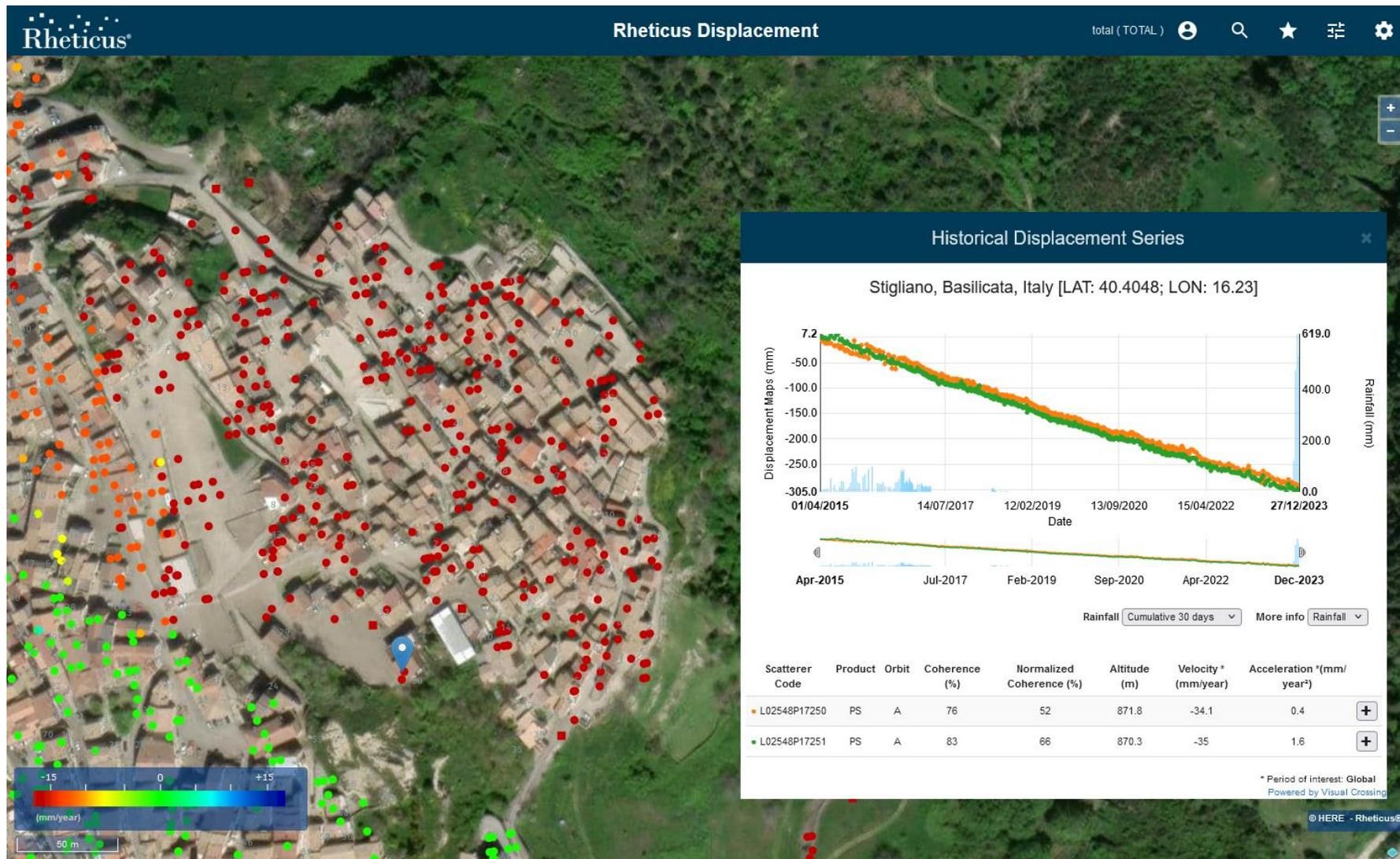
Figura 10: Visualizzazione dei soli PS/DS caratterizzati da una velocità media di abbassamento superiore a -20 mm/anno. Il grafico mostra le serie temporali di 2 PS (evidenziati dal puntatore blu nell'immagine – CODE: L02548P17250, L02548P17251) a più alta velocità situato nella zona Nord-Est del centro abitato di Stigliano caratterizzato da una velocità media in orbita Ascending pari a circa -35 mm/anno in linea con quanto misurato nel precedente rapporto [RD15].
