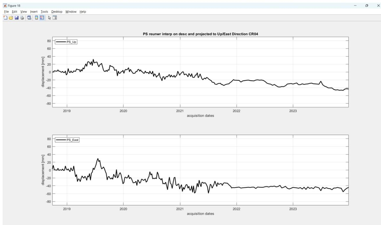
Figura 23: il grafico in alto rappresenta la serie temporale di spostamento in direzione Verticale (PS\_Up) mentre il grafico in basso rappresenta la serie temporale di spostamento in direzione est (PS\_Est).
