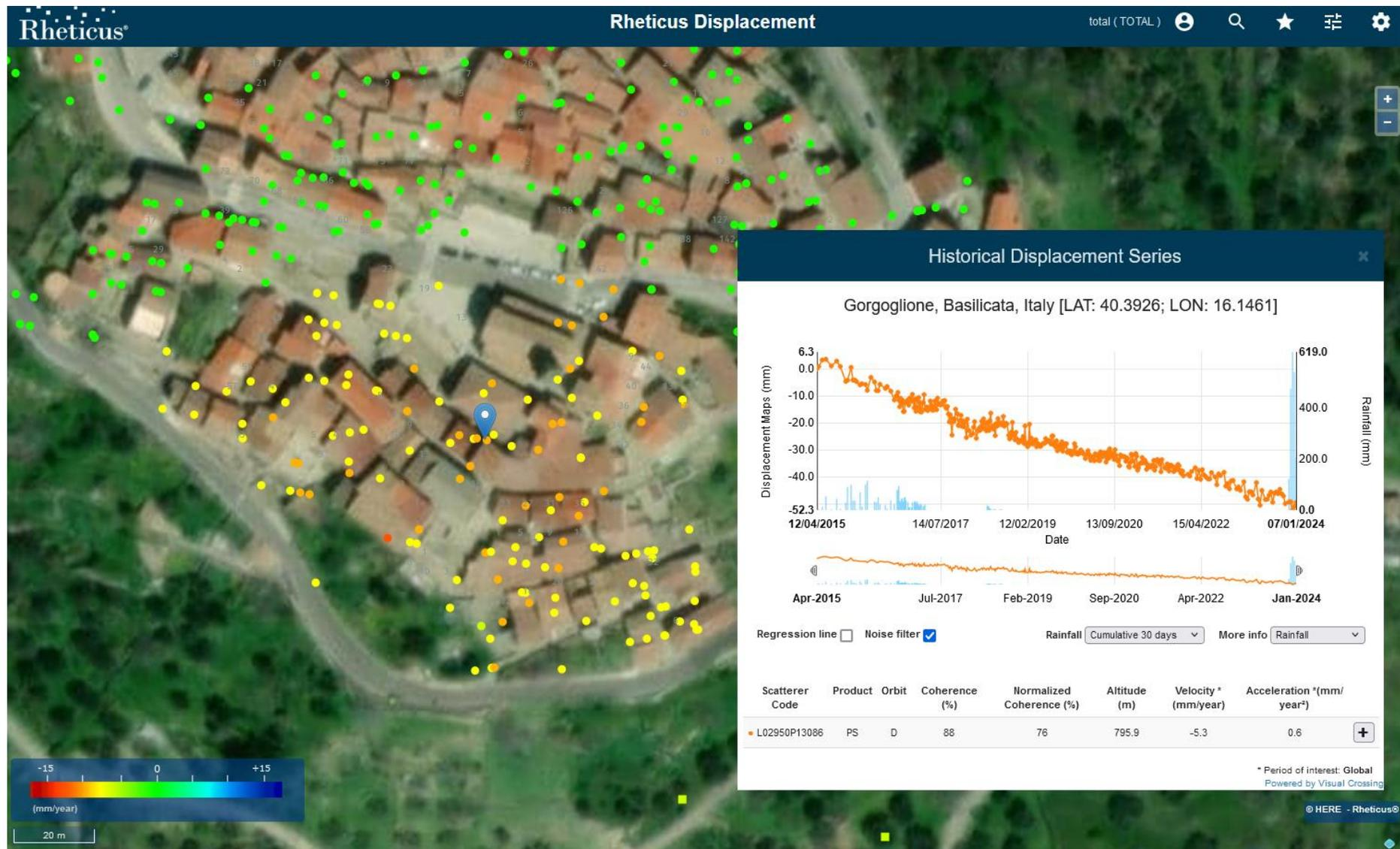
Figura 8: Serie temporale del PS (evidenziato dal puntatore blu nell'immagine) ad alta coerenza (0.88) situato al centro dell'area in movimento del centro abitato di **Gorgoglione**. La velocità media del PS sul periodo esteso a Dicembre 2023 è pari a -5.3 mm/anno in linea con quanto misurato nel precedente rapporto [RD15].
