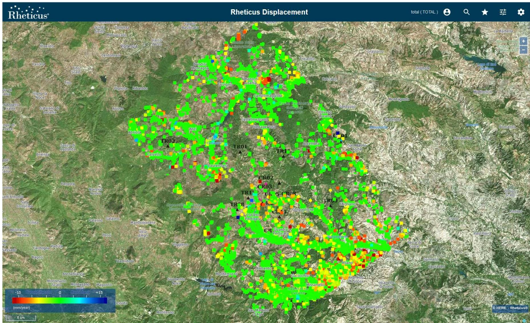
Figura 4: Mappa velocità media annua (mm/anno) lungo la LOS sul periodo esteso a Dicembre 2023 ottenuta dal processamento del dataset Sentinel-1 in orbita descending.
