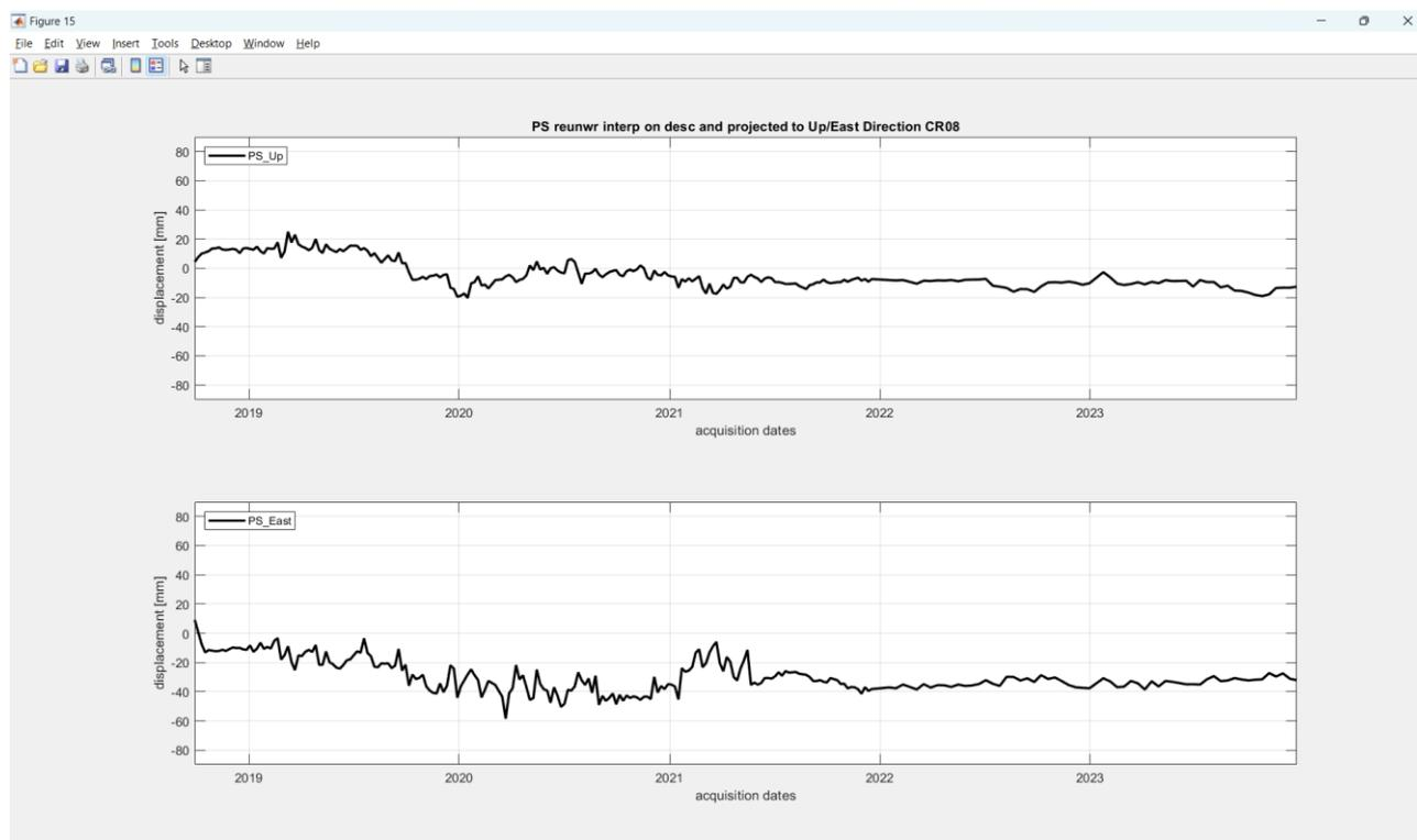
Figura 26: il grafico in alto rappresenta la serie temporale di spostamento in direzione Verticale (PS\_Up) mentre il grafico in basso rappresenta la serie temporale di spostamento in direzione est (PS\_Est).
