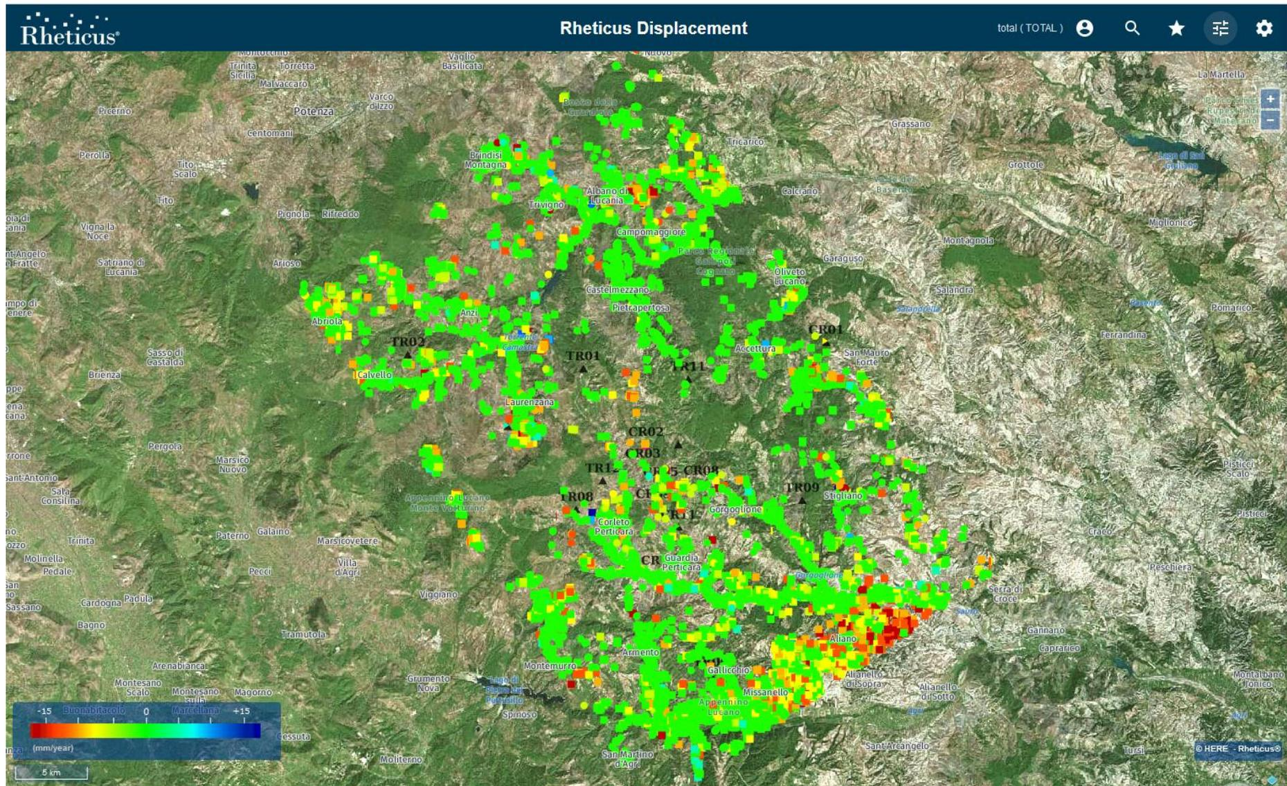
Figura 3: Mappa velocità media annua (mm/anno) lungo la LOS sul periodo esteso a Dicembre 2023 ottenuta dal processamento del dataset Sentinel-1 in orbita ascending.
