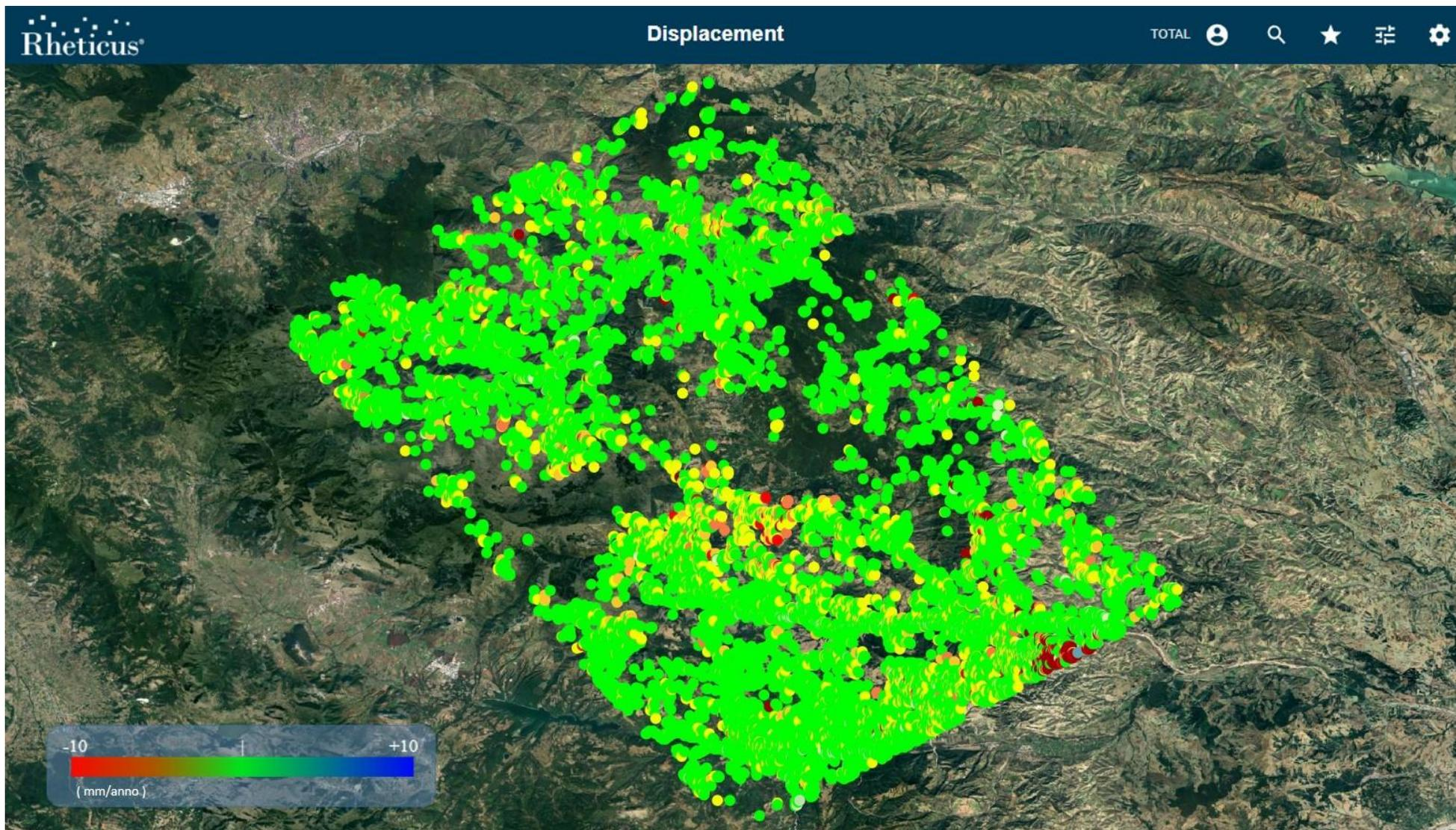
Figura 5: Mappa velocità media annua (mm/anno) lungo la direzione verticale sul periodo esteso a Dicembre 2023 ottenuta dalla combinazione delle immagini Ascending e Descending acquisite dal satellite Sentinel-1.
