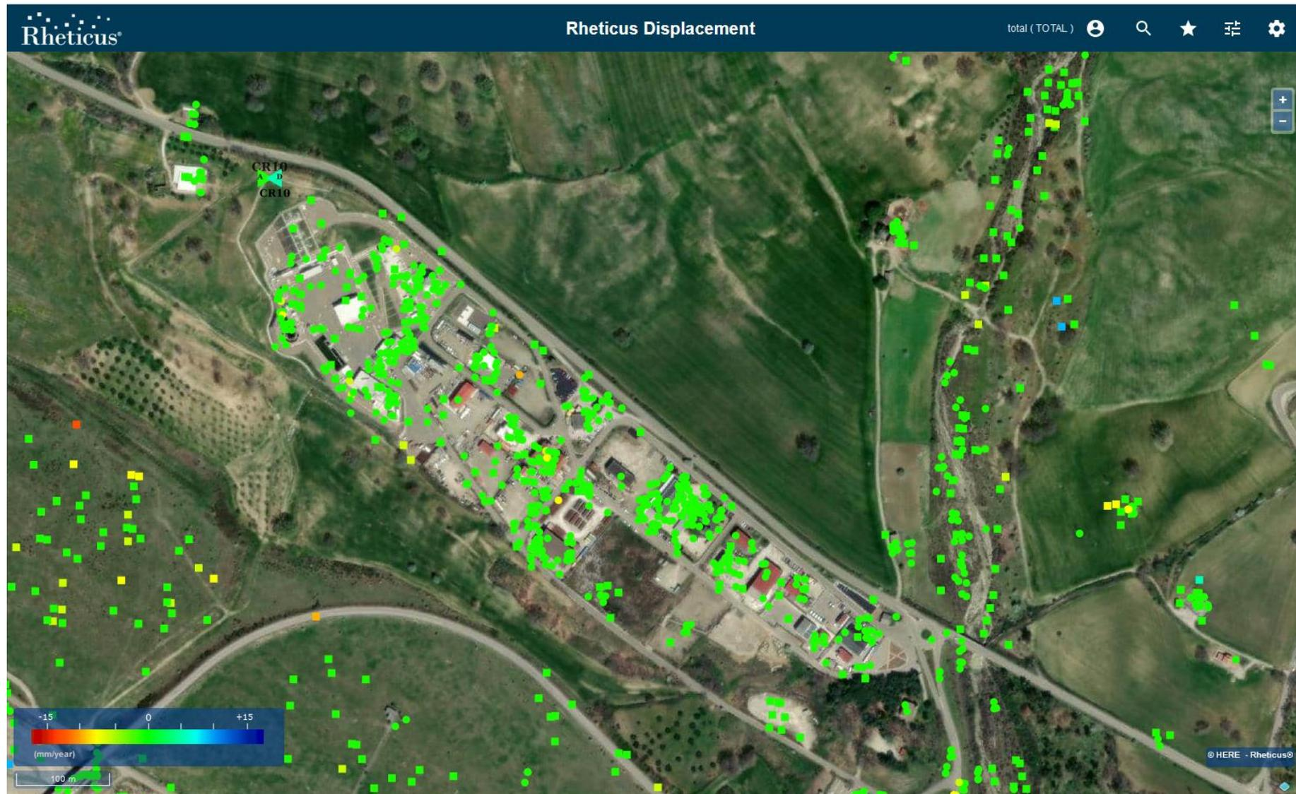
Figura 30: **LPG Center** caratterizzato da una buona copertura di PS e dai quali nel periodo esteso a Dicembre 2023, non si evincono variazioni significative di velocità media rispetto al precedente rapporto [RD15].
