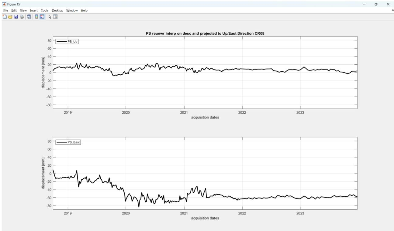
Figura 17: il grafico in alto rappresenta la serie temporale di spostamento in direzione Verticale (PS\_Up) mentre il grafico in basso rappresenta la serie temporale di spostamento in direzione est (PS\_Est).
