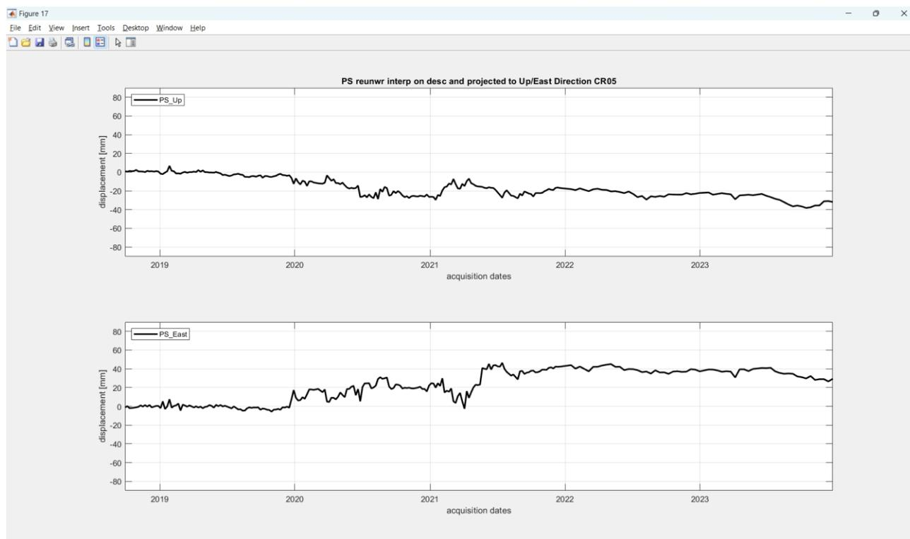
Figura 14: il grafico in alto rappresenta la serie temporale di spostamento in direzione Verticale (PS\_Up) mentre il grafico in basso rappresenta la serie temporale di spostamento in direzione est (PS\_Est).
