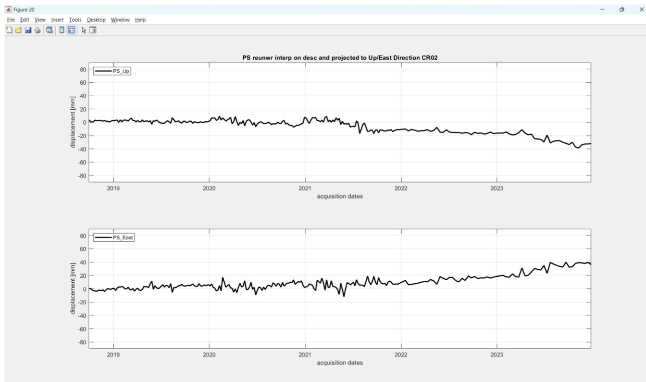
Figura 20: il grafico in alto rappresenta la serie temporale di spostamento in direzione Verticale (PS\_Up) mentre il grafico in basso rappresenta la serie temporale di spostamento in direzione est (PS\_Est).
