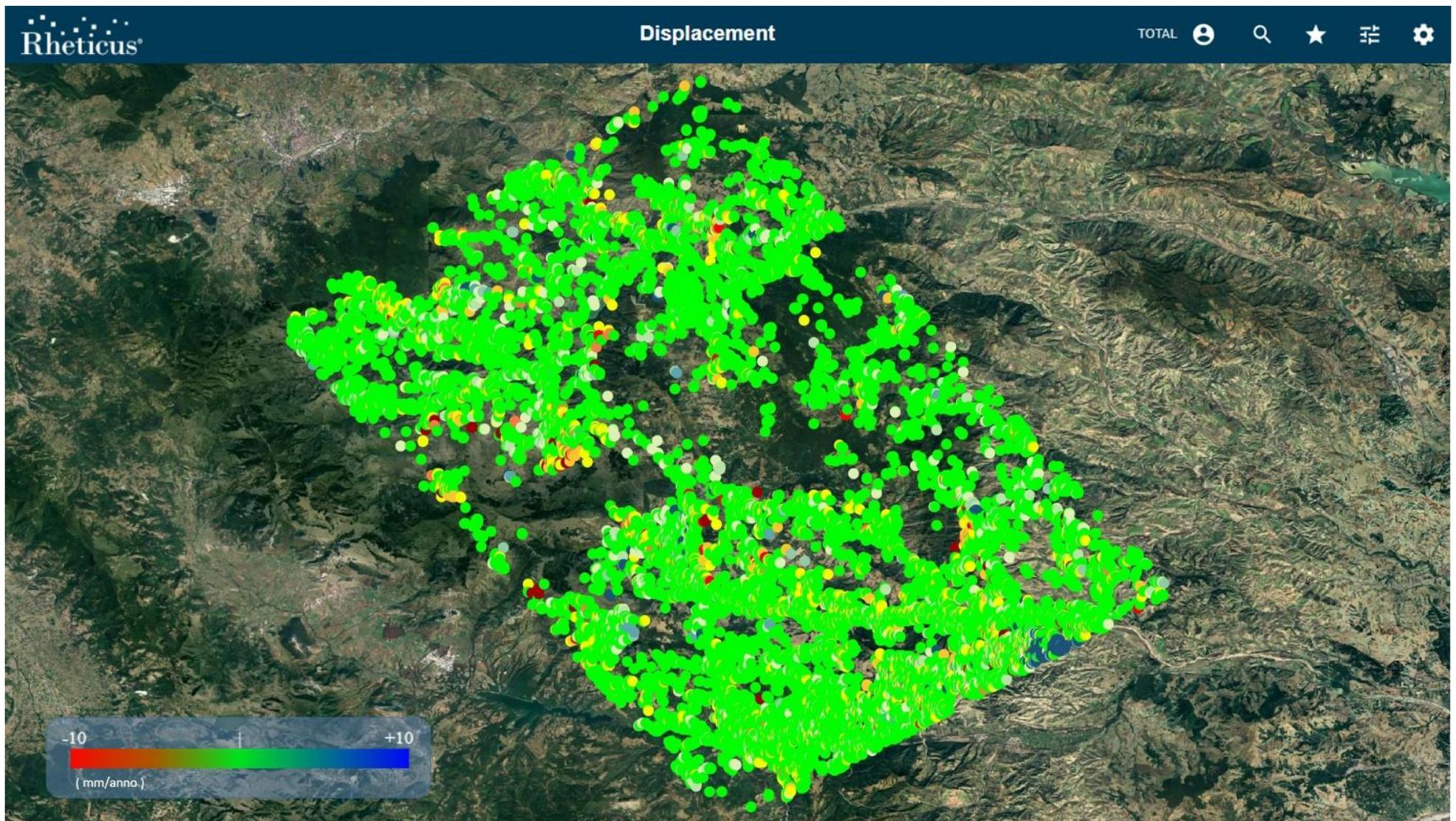
Figura 6: Mappa velocità media annua (mm/anno) in direzione Est(+) - Ovest(-) sul periodo esteso a Dicembre 2023 ottenuta dalla combinazione delle immagini Ascending e Descending acquisite dal satellite Sentinel-1.
