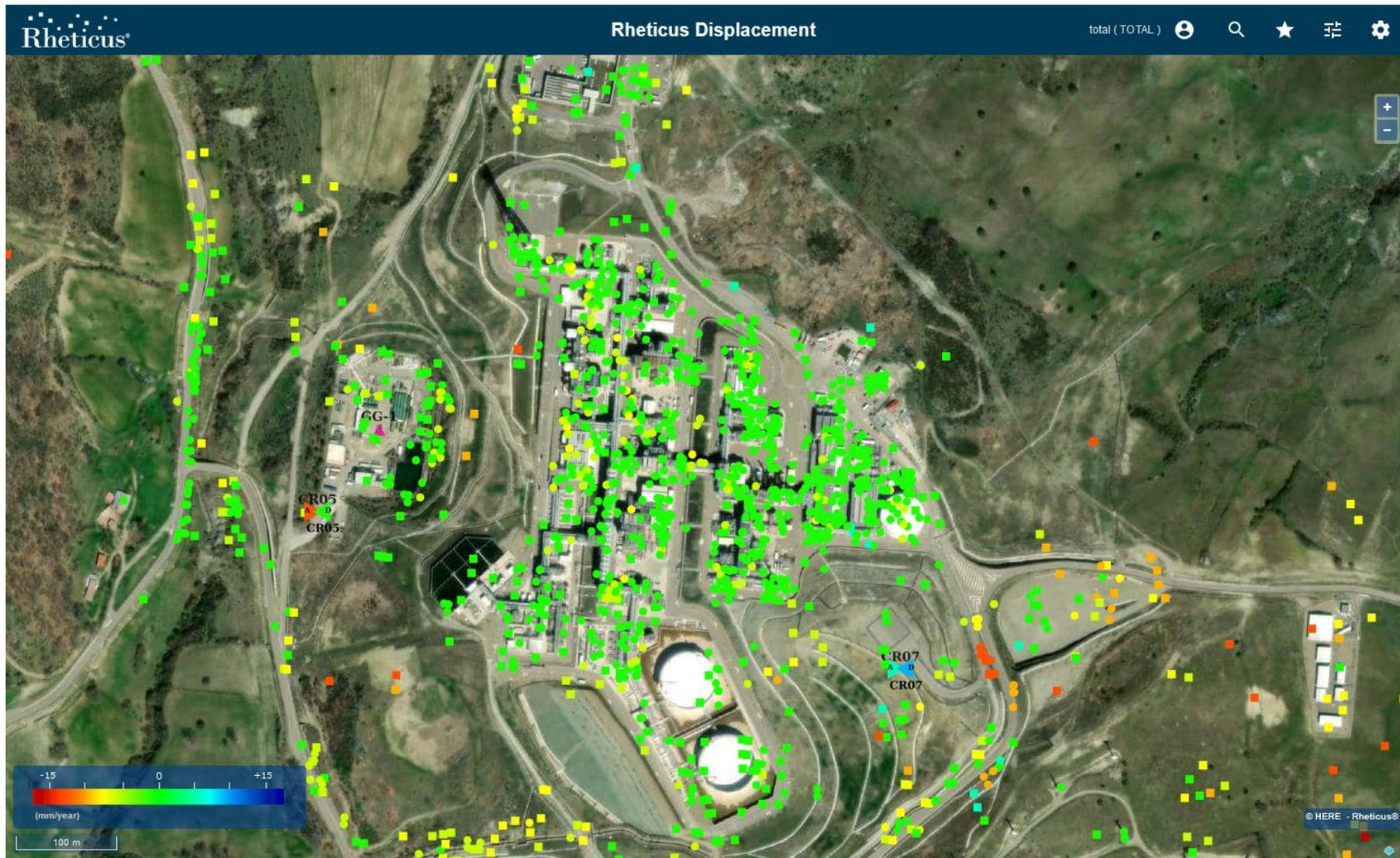
Figura 33: Oil Center caratterizzato da una buona copertura di PS e dai quali nel periodo esteso a Dicembre 2023, non si evincono variazioni significative di velocità media rispetto al precedente rapporto [RD15].
