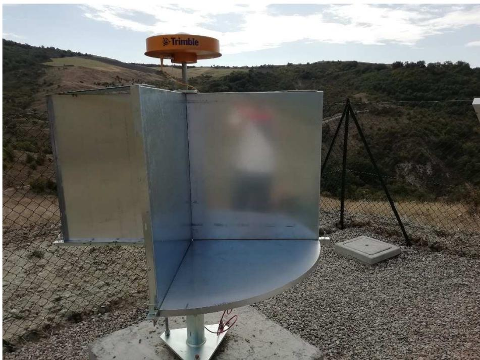
**Figura 2** – Antenna Chocke Ring installata al centro di un corner reflector.
