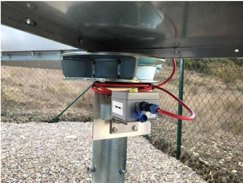
Figura 3 – Inclinometro biassiale installato sul palo di sostegno di un corner reflector dotato di antenna GNSS alla sommità.
